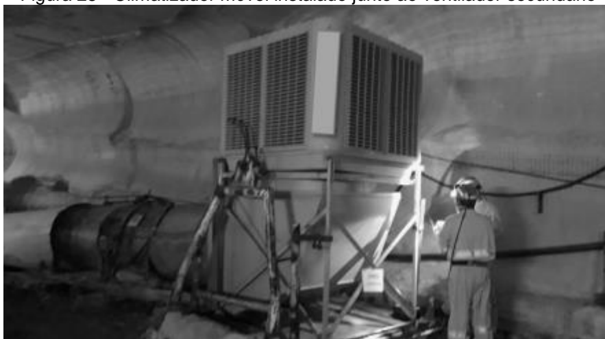
Figura 28 - Climatizador móvel instalado junto ao ventilador secundário
