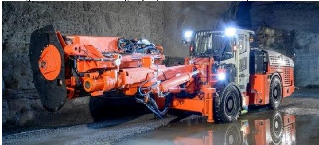
Figura 11 - Cabine com Refrigeração para trabalho em mineração subterrânea
