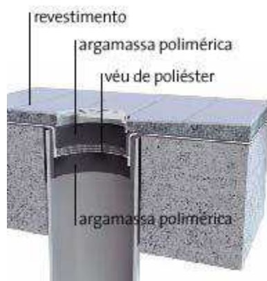
Figura 38 - Detalhe da impermeabilização dos ralos. (Fonte: http://www.imperacqua.com.br/ )
