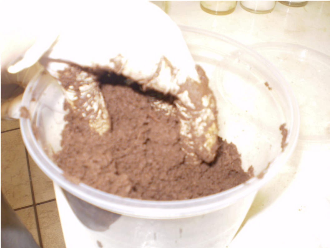
Figura 6 – Verificação da umidade da amostra
