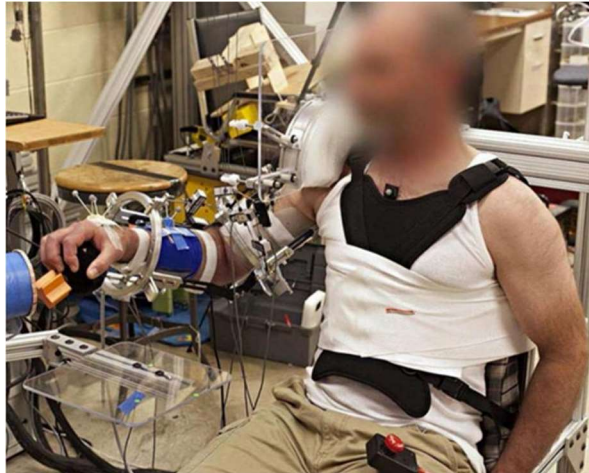
Figura 5 - Exoesqueleto movido à cabos (1)
