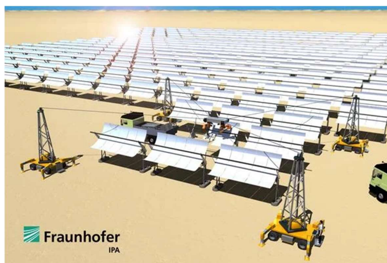
Figura 4 - CDPR sendo utilizado em uma planta solar
