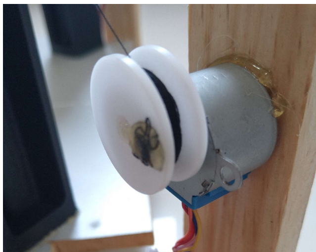
Figura 29 – Fixação dos motores
