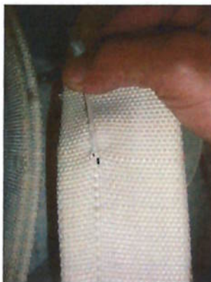
Figura anexo 4-Mangueira do hidrante furada
