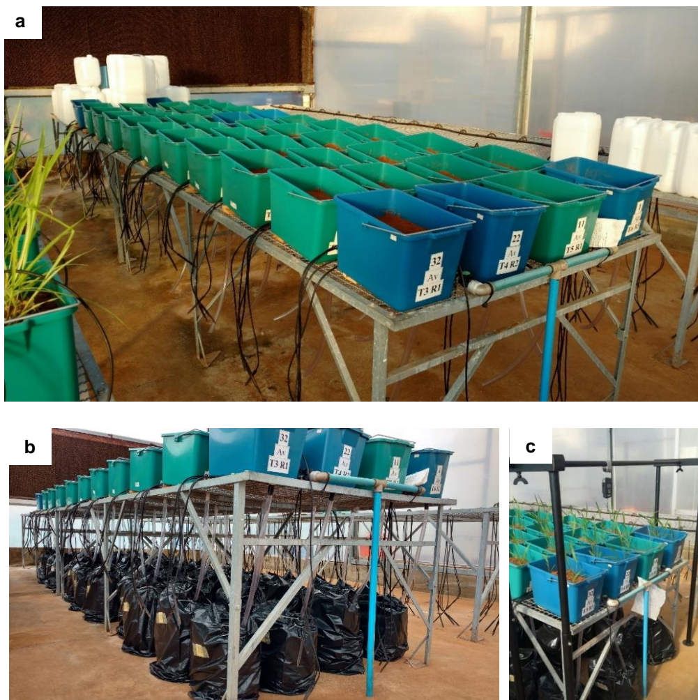
Figura 4. a. Alocação dos vasos sob nas bancadas; b. Galões abaixo dos vasos para armazenamento dos lixiviados; c. Detalhes do sistema de balança para pesagem dos vasos.
