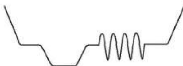
Figura 5-3 - Sinal Analógico de Sincronização Horizontal de uma Câmera Matricial
