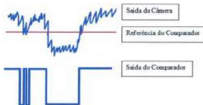
Figura 10-4 - Filtragem da imagem por Hardware (comparador) com Ruído
