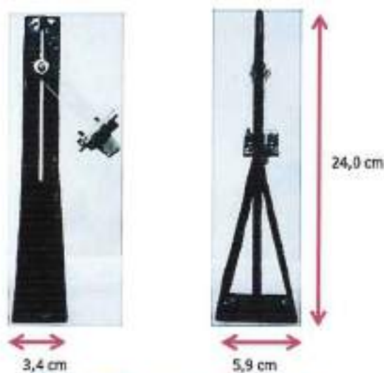
Figura 3-4 Haste e suporte da câmera.
