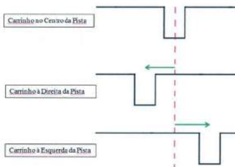
Figura 10-1 - Sinal da Câmera em Relação à posição do Carrinho
