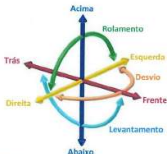
Figura 5-7 - Os seis graus de liberdade de um objeto. Adaptada de [10]
