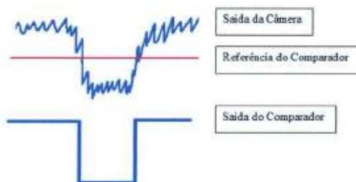
Figura 10-3 - Filtragem da imagem por Hardware (comparador)
