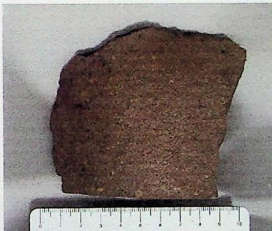
Foto 03 - Dacito, com textura fannerítica, fenocristais de plagioclásio e matriz composta essencialmente por plagioclásio e piroxênio. escala em centímetros.
