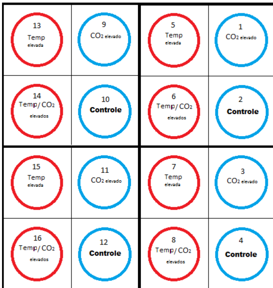
Figura 2. Esquema da distribuição dos tratamentos pela área experimental. As linhas delimitam os quatro blocos experimentais. Temp elevada (eT) = tratamento de aquecimento, com temperatura elevada em 2°C em relação ao controle, CO 2 elevado (eC) = tratamento de elevado CO 2 , com [CO 2 ] = 600ppm e temp/CO 2 elevados (eC + eT) = combinação de elevado CO 2 (600 ppm) e elevada temperatura (+2°C).
