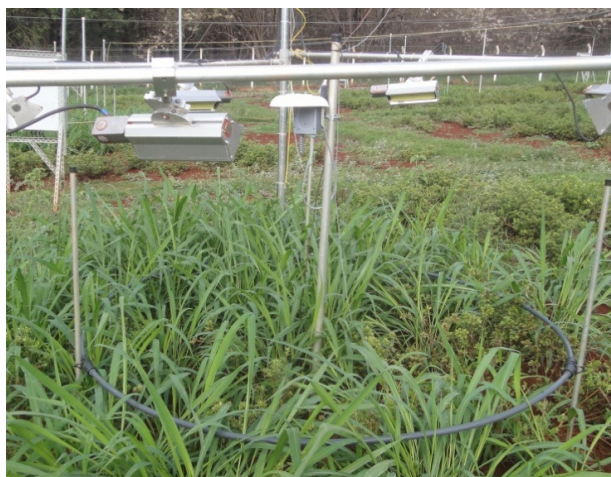
Figura 3. Parcela experimental do sistema miniFACE, delimitada pelo anel de fumigação de CO 2 . No centro da parcela ha um sensor que mede a concentração de CO 2 (IRGA) (apontado pela seta). Durante o experimento tanto o anel como o IRGA são ajustados a altura do dossel das plantas.
