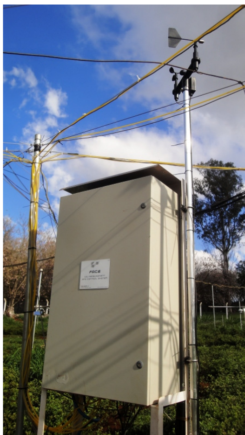
Figura 5. Vista externa da unidade central de controle do FACE e anemômetro, instalados na região central da área experimental.
