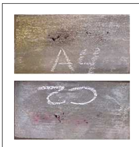
Figura 23 – Corte do material na posição do rechupe no cilindro Projeto A Fonte: Voith 2011
