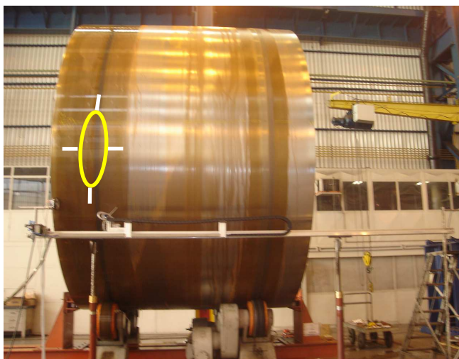
Figura 21 - Visualização da localização da falha no cilindro Projeto A Fonte: Voith 2011
