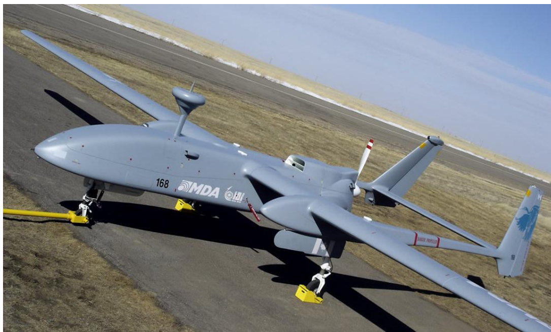
Figura 1.1: VANT – Veículo Autônomo Não Tripulado: forte uso de materiais compósitos (fonte: [5]).
