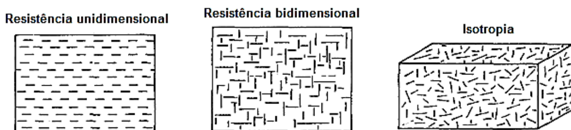
Figura 4.1: Três tipos de orientação de fibras (adaptado de [6]).
