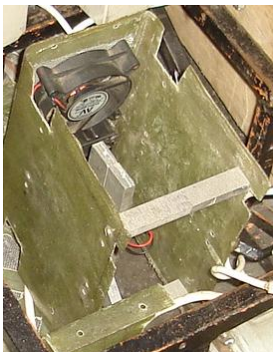
Figura 1.3: Compartimento de eletrônica de fibra de vidro – Equipe ThundeRatz.
