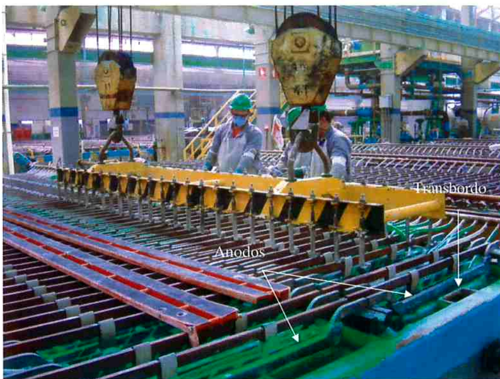
Figura 4 - Célula Eletrolítica da VMN-SMP indicando alguns de seus elementos de construção (Cortesia da Equipe da Engenharia de Processos da Votorantim Metais Níquel – Unidade de São Miguel Paulista).
