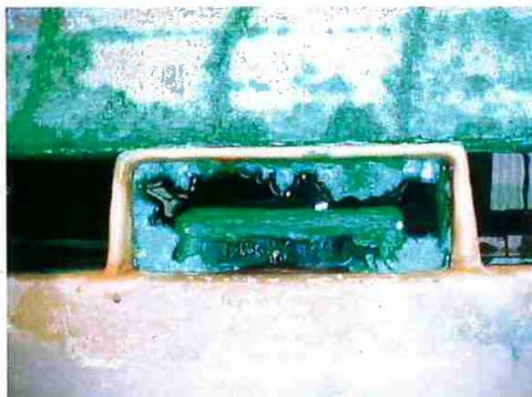
Figura 10 - Transbordo de uma Célula eletrolítica da VMN-SMP em estágio avançado de incrustações de sulfato de cálcio, onde se verifica a obstrução total do transbordo e, conseqüentemente, a parada da célula eletrolítica para realização de limpeza (Cortesia da Equipe da Engenharia de Processos da Votorantim Metais Níquel – Unidade de São Miguel Paulista).
