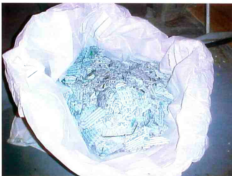
Figura 15 – Material incrustado removido do mesmo trocador de calor da Figura 7 (Cortesia da Equipe da Engenharia de Processos da Votorantim Metais Níquel – Unidade de São Miguel Paulista).
