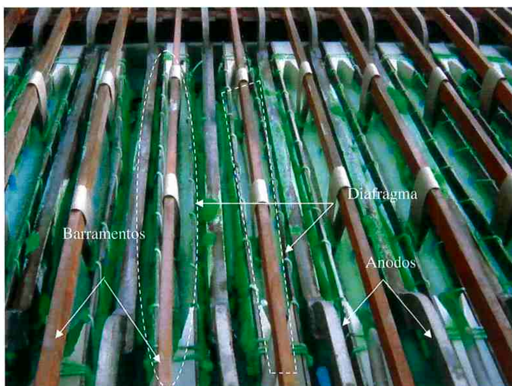
Figura 5 - Célula Eletrolítica da VMN-SMP indicando alguns de seus elementos de construção (Cortesia da Equipe da Engenharia de Processos da Votorantim Metais Níquel – Unidade de São Miguel Paulista).
