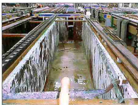
Figura 8 - Célula Eletrolítica da VMN-SMP após remoção da impregnação de sulfato de cálcio (Cortesia da Equipe da Engenharia de Processos da Votorantim Metais Níquel – Unidade de São Miguel Paulista). Observe que a remoção não consegue eliminar toda a incrustação, além de causar degradação acentuada do revestimento interno da célula eletrolítica.
