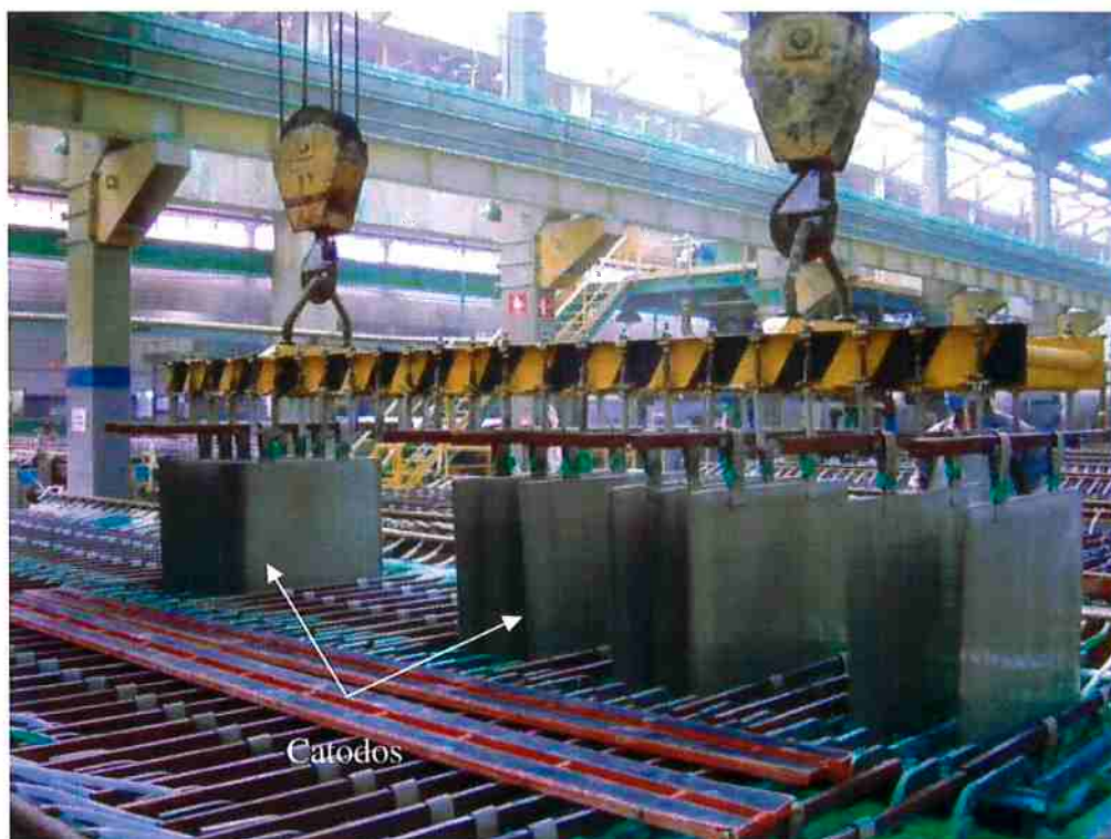
Figura 6 – Célula Eletrolítica da VMN-SMP indicando alguns de seus elementos de construção (Cortesia da Equipe da Engenharia de Processos da Votorantim Metais Níquel – Unidade de São Miguel Paulista).
