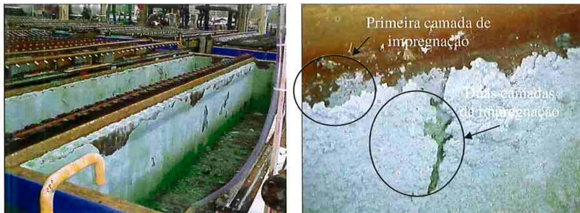
Figura 7 - Célula Eletrolítica da VMN-SMP com impregnação de sulfato de cálcio (Cortesia da Equipe da Engenharia de Processos da Votorantim Metais Níquel – Unidade de São Miguel Paulista).
