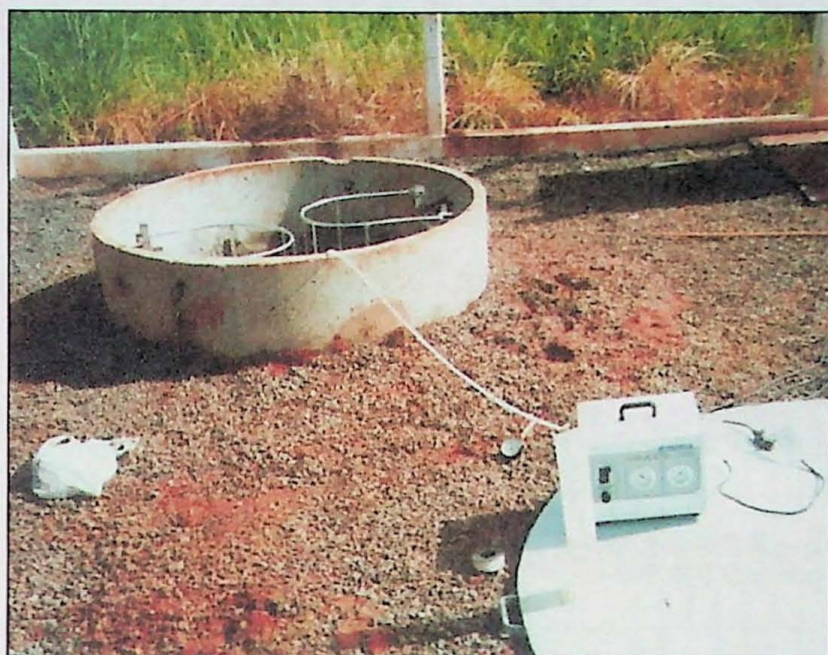
Fotografia 3 – Configuração do poço da estação de monitoramento durante processo de amostragem com uma bomba a vácuo.
