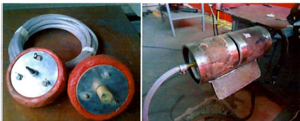
Figura 4.5 – Fotos ilustrativas do dispositivo "tampão" utilizado nas soldagens.
