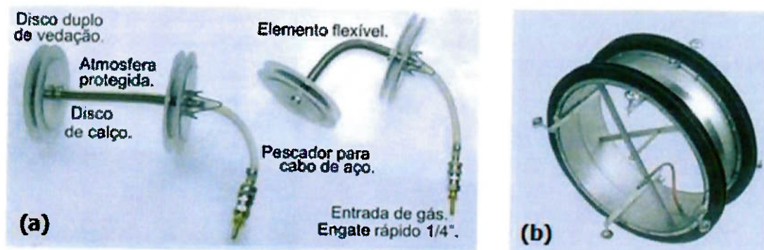
Figura 2.13 – Exemplos de dispositivos de tampão reutilizáveis. (a) Diâmetros abaixo de 315 mm e (b) Diâmetros acima de 300 mm [15].
