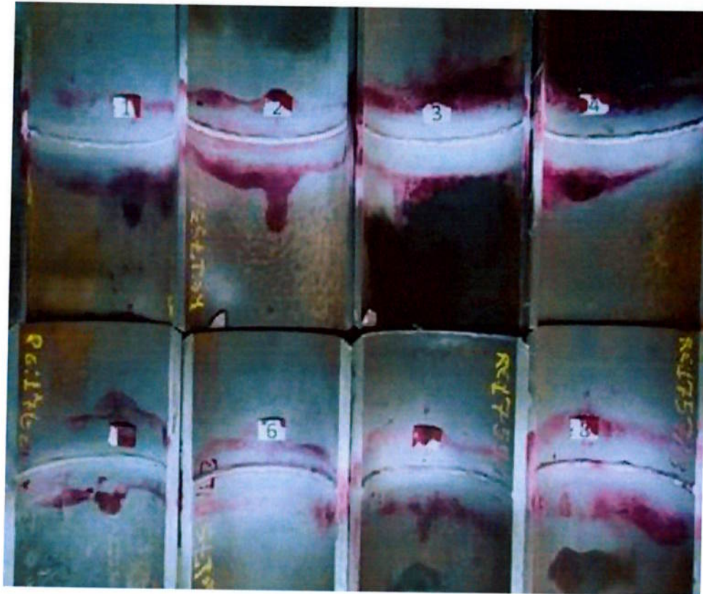
Figura 5.4 – Foto da aplicação do revelador nas amostras.
