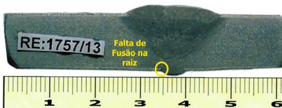
Figura 5.13 – Macrografia das amostras do CP 8 (sem purga e sem limpeza).
