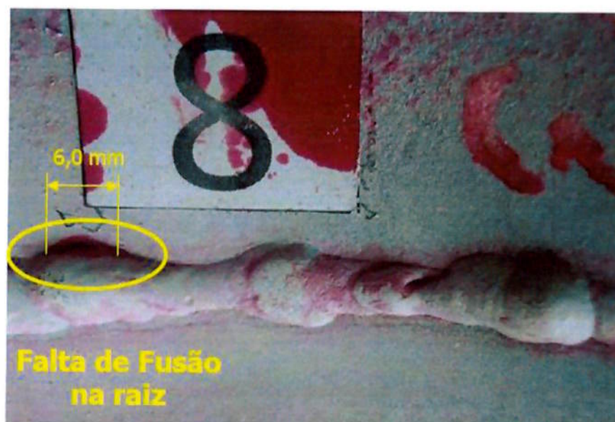
Figura 5.1 – Foto da FF de 6,0 mm encontrada no CP 8.
