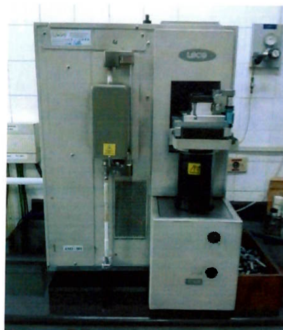
Figura 4.11 – Equipamento de análise química via combustão da marca LECO usado neste trabalho.
