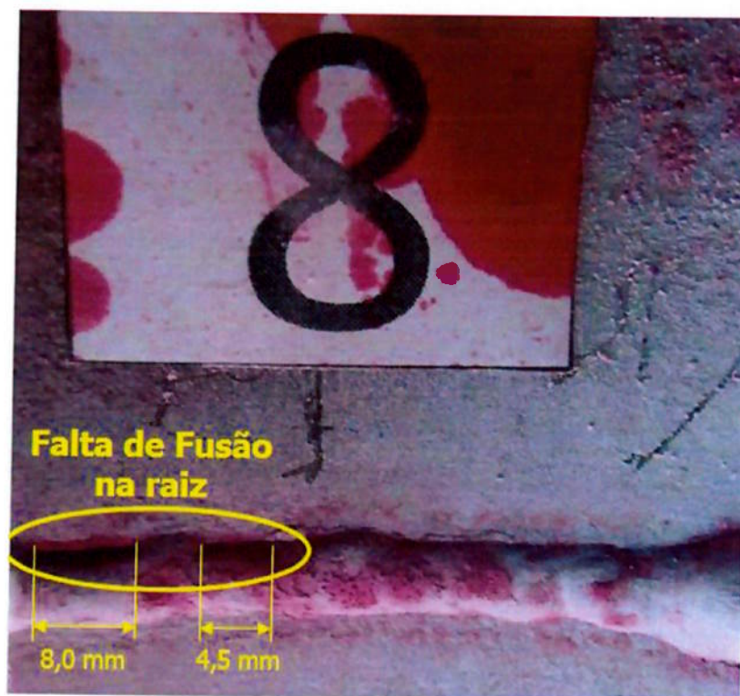
Figura 5.2 – Foto das FF de 8,0 e 4,5 mm encontradas no CP 8.
