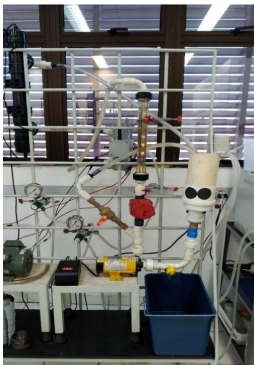
Figura 9. Fotografia do reator de fluxo em batelada utilizado e esquema dos componentes com fluxo de funcionamento.
