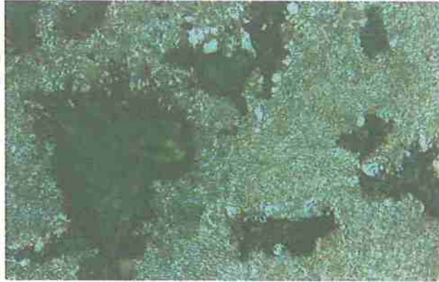
Figura 45: Micrografia da região inicial de têmpera para faixas de 30 mm (ataque nital, aumento de 160x)
