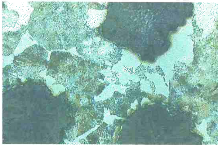
Figura 16: Micrografia do GGG-60, com 80% de perlita (aumento 160x, ataque nital) (11)
