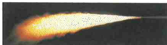
Acetileno queimando no ar, T_{\text{máx}} 815°C
