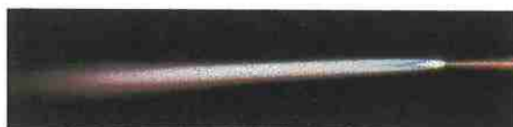
Chama levemente carburante, T_{\text{máx}} 3.200°C
