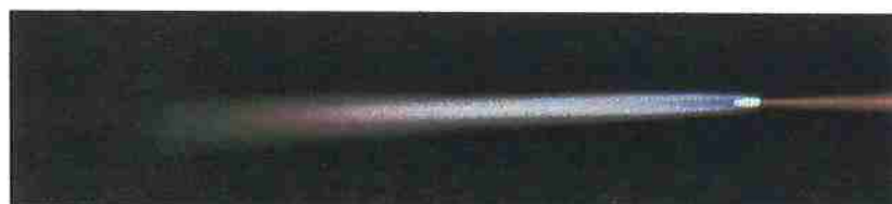
Figura 26: Chama neutra utilizado no processo (5)
