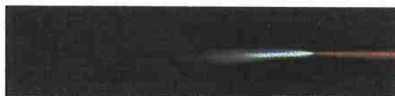
Chama Oxidante, T_{\text{máx}} 3.315°C
