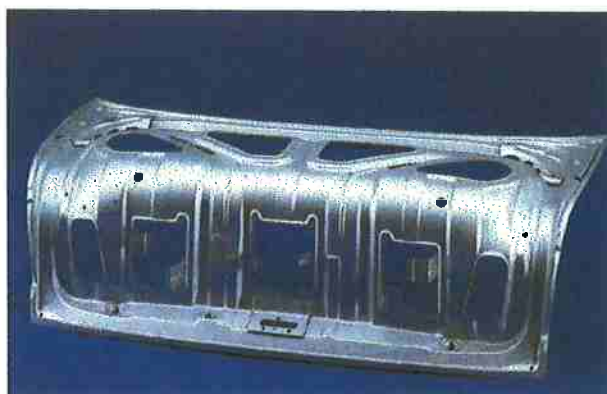
Figura 31: Conforme a peça estampada, sua ferramenta fica altamente susceptível às trincas térmicas e desgaste excessivo (baixa dureza), devido ao superaquecimento causado no processo de têmpera à chama (7)
