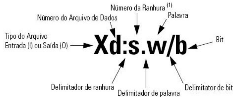
Figura 6 – Esquema de Endereçamento padrão Rockwell Automation
