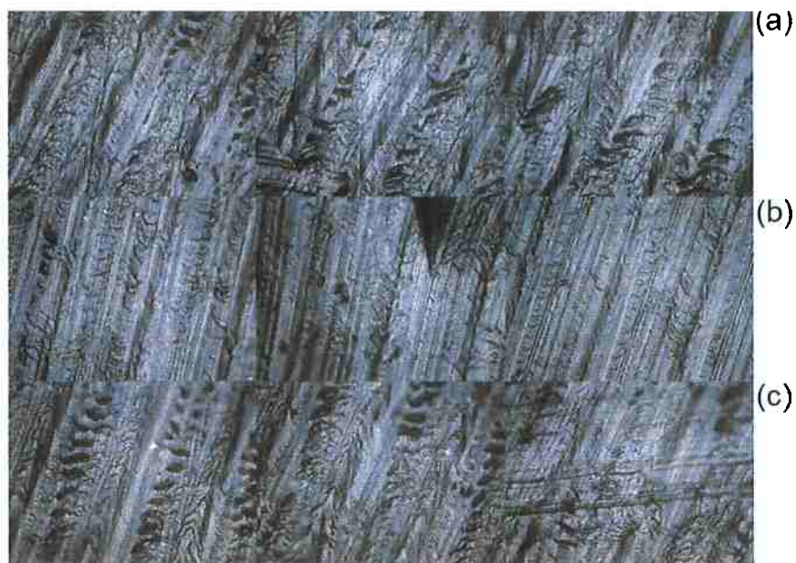
Figura 46 Microscopia óptica da amostra de PEUAPM antes da imersão em etanol (a), após 30 dias de imersão em etanol à temperatura ambiente (b) e após 30 dias de imersão em etanol à 60°C (c) (Seixas, 2013).
