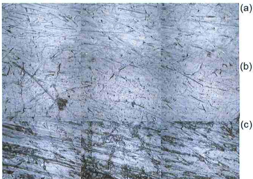
Figura 44 Microscopia óptica da amostra de PA 6,6 Radilon RV 300 antes da imersão em etanol (a), após 30 dias de imersão em etanol à temperatura ambiente (b) e após 30 dias de imersão em etanol à 60°C (c) (Seixas, 2013).
