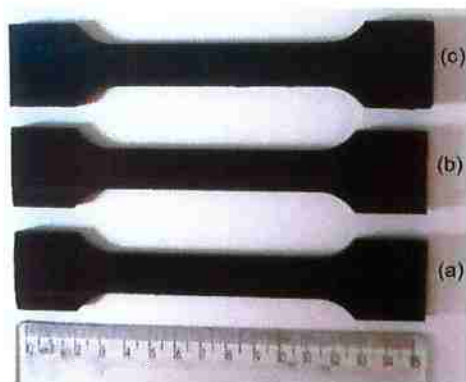
Figura 30 Corpos de prova de PA 66 Heramid não imerso em etanol (a), após imersão em etanol à temperatura ambiente (b) e após imersão em etanol à 60°C (c) (Seixas, 2013).
