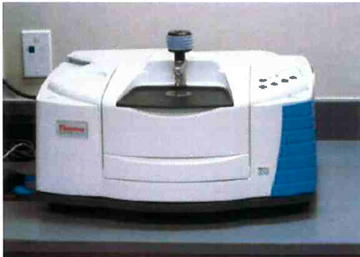
Figura 27 Equipamento de análise de infravermelho com acesso de refletância (Seixas, 2013).
