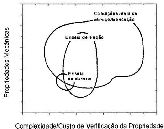
Figura 21 Representação esquemática da relação entre propriedades mecânicas do material obtidas por um ensaio mecânico e sua complexidade e custo (Morais, 2004).
