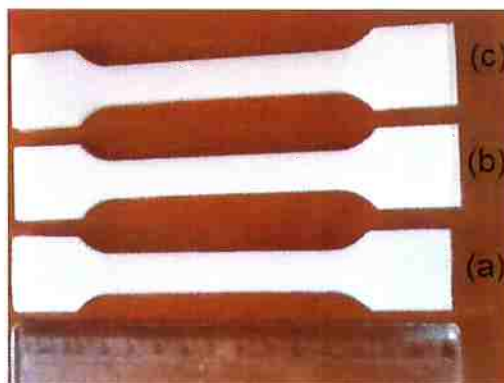
Figura 31 Corpos de prova de PA 66 Radilon RV 300 não imerso em etanol (a), após imersão em etanol à temperatura ambiente (b) e após imersão em etanol à 60°C (Seixas, 2013).
