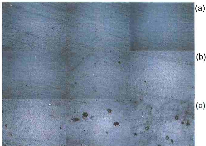
Figura 42 Microscopia óptica de amostras de PU poliéster antes do contato com etanol (a), após 30 dias de imersão em etanol à temperatura ambiente (b) e após 30 dias de imersão em etanol à 60°C (c) (Seixas, 2013).
