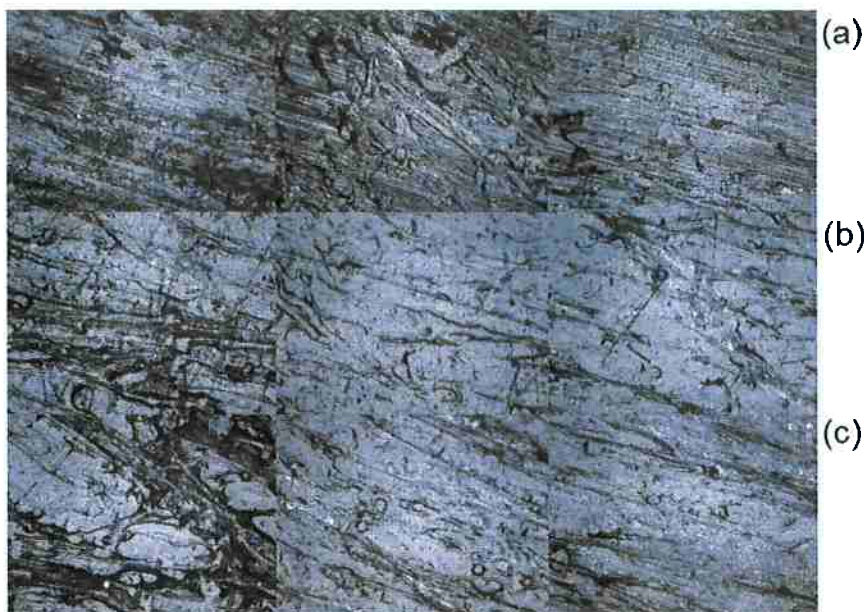
Figura 43 Microscopia óptica da amostra de PA 6,6 Heramid antes do ensaio de imersão em etanol (a), após 30 dias de imersão em etanol à temperatura ambiente (b), e após 30 dias de imersão em etanol à 60°C (c) (Seixas, 2013).
