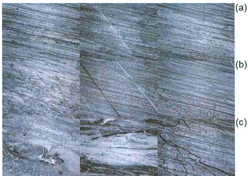
Figura 45 Microscopia óptica da amostra de PA 6,6 Radilon HSLW antes da imersão em etanol (a), após 30 dias de imersão em etanol à temperatura ambiente (b) e após 30 dias de imersão em etanol à 60°C (c) (Seixas).
