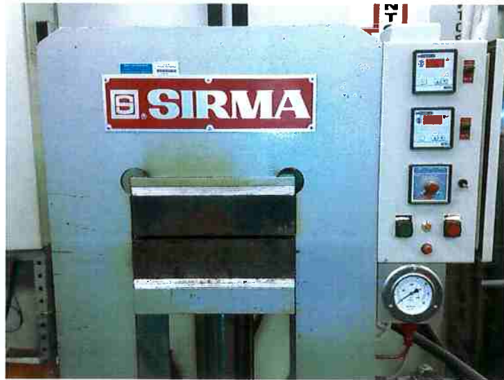
Figura 19 - Prensa hidráulica utilizada para moldar as placas de PVC
