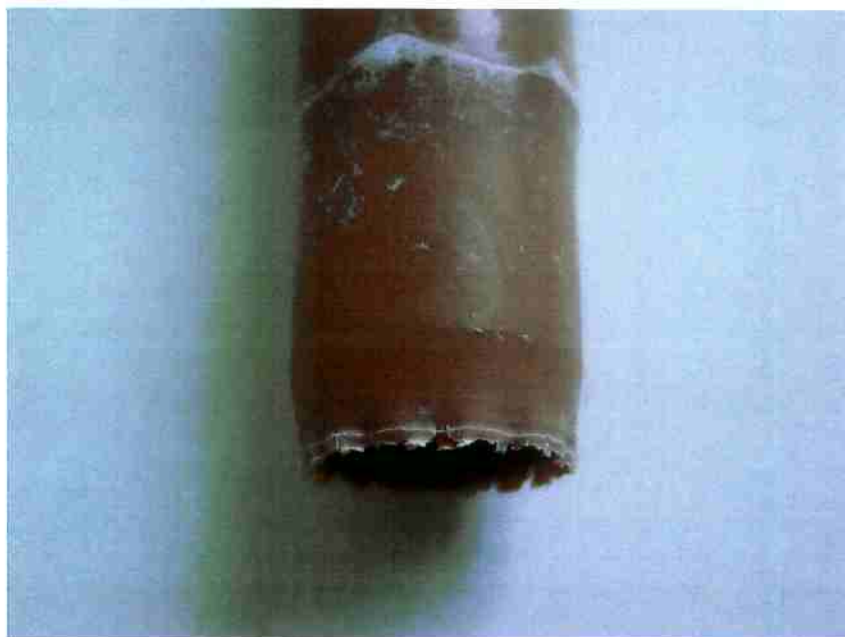
Figura 27 – Resultado da amostra 5764 A no ensaio de imersão em cloreto de metileno na parte chanfrada
