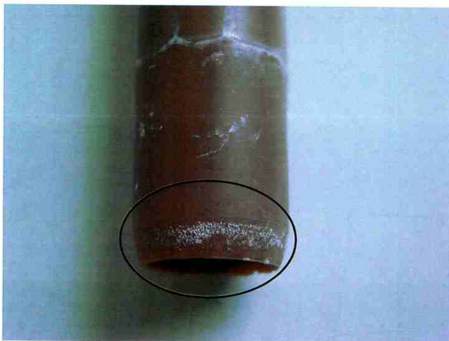
Figura 25 – Resultado da amostra 5749 A no ensaio de imersão em cloreto de metileno na parte chanfrada
