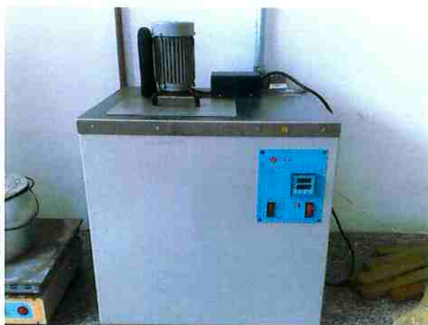
Figura 18 – Equipamento de banho ultratermostático utilizado no ensaio
