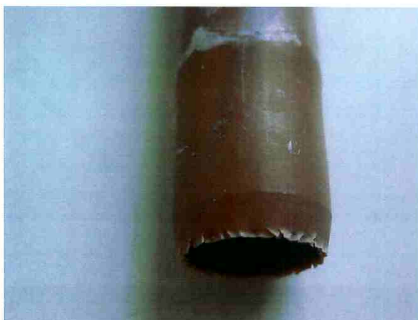
Figura 28 - Resultado da amostra 5764 B no ensaio de imersão em cloreto de metileno na parte chanfrada
