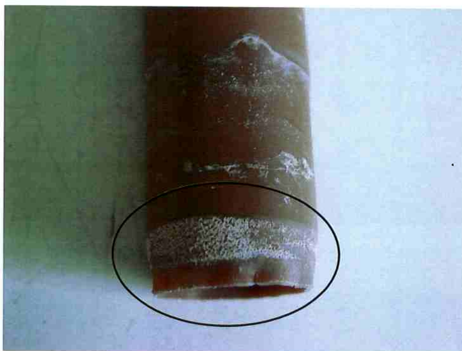
Figura 26 – Resultado da amostra 5749 B no ensaio de imersão em cloreto de metileno na parte chanfrada
