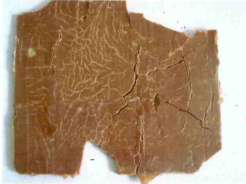
Figura 22 - Placa sem fusão das camadas internas
