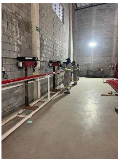
Figura 40 – Bancada para furação de ramais (Fonte: Autora)
