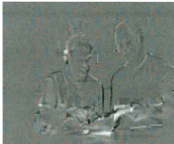
Figura 2.10: Quadro Residual Com compensação com Blocos de 16 x 16 Pixels.
