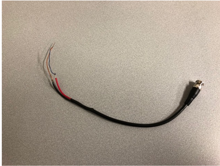
Figura 22: Ponta de prova para medição das antenas das etiquetas. Fonte: elaborado pelo autor
