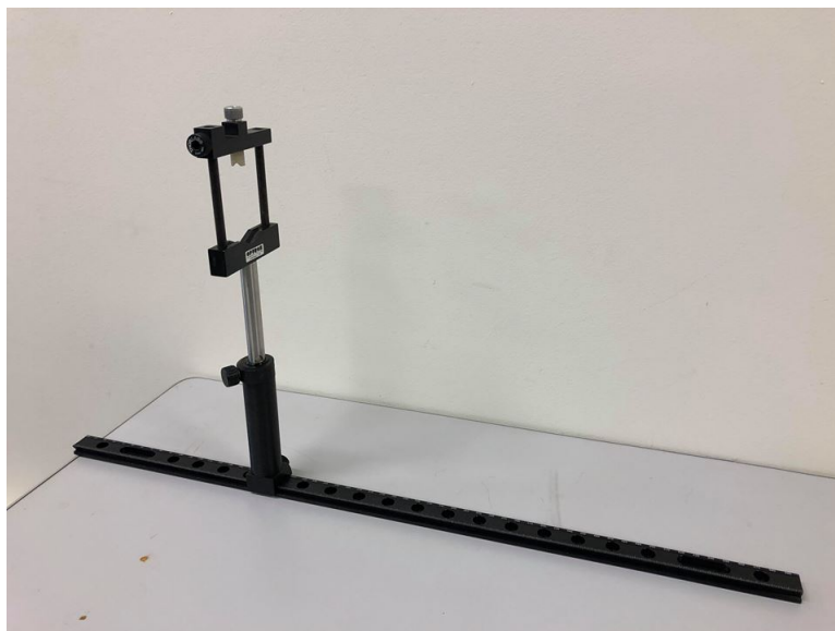
Figura 20: Suporte milimetrado para as etiquetas RFID. Fonte: elaborado pelo autor
