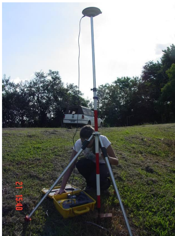
Figura 13: Base de implantação do GPS de precisão.
