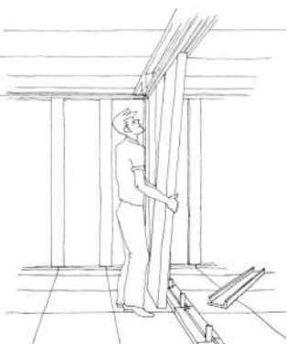
Encaixe painéis divisórios, Instituto Lina Bo Bardi e P.M. Bardi
