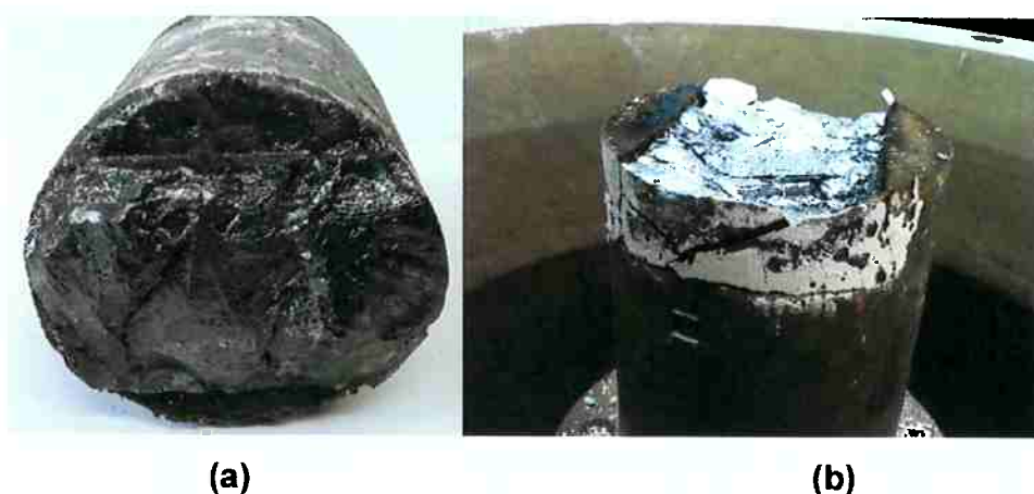
Figura 32- Corrida EB46. (a) mostra a região de fratura do lingote. (b) mostra o suporte de cobre com a outra parte fraturada do lingote. Observa-se que a fratura é relativamente plana e que ocorre na borda superior dos braços do suporte de cobre.
