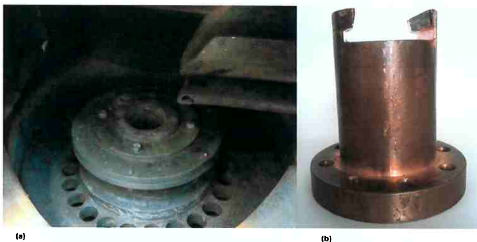
Figura 26- Visão interna da câmara do forno. (a) Visão do cristalizador de 60 mm de diâmetro, no qual é encaixado o suporte de cobre pela parte inferior e a alimentadora de grânulos localizada acima do cristalizador. (b) suporte de cobre.
