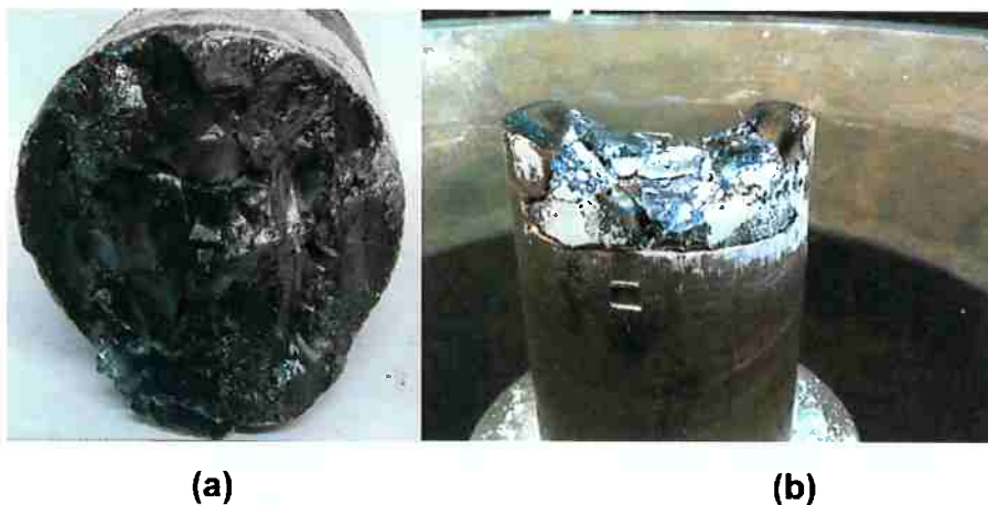
Figura 33- Corrida EB48. a) mostra a região da fratura do lingote. (b) mostra o suporte de cobre com a outra parte fraturada do lingote. Observa-se que a fratura é relativamente plana e que ocorre na borda superior dos braços do suporte de cobre.
