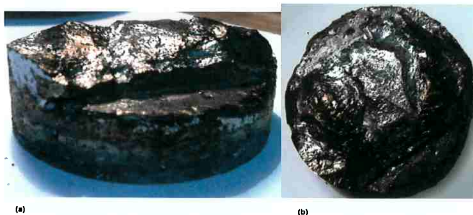
Figura 27- Lingote cortado transversalmente perto da região da fratura. (a) vista frontal. Fratura localizada na parte superior da imagem, (b) vista superior da região da fratura.
