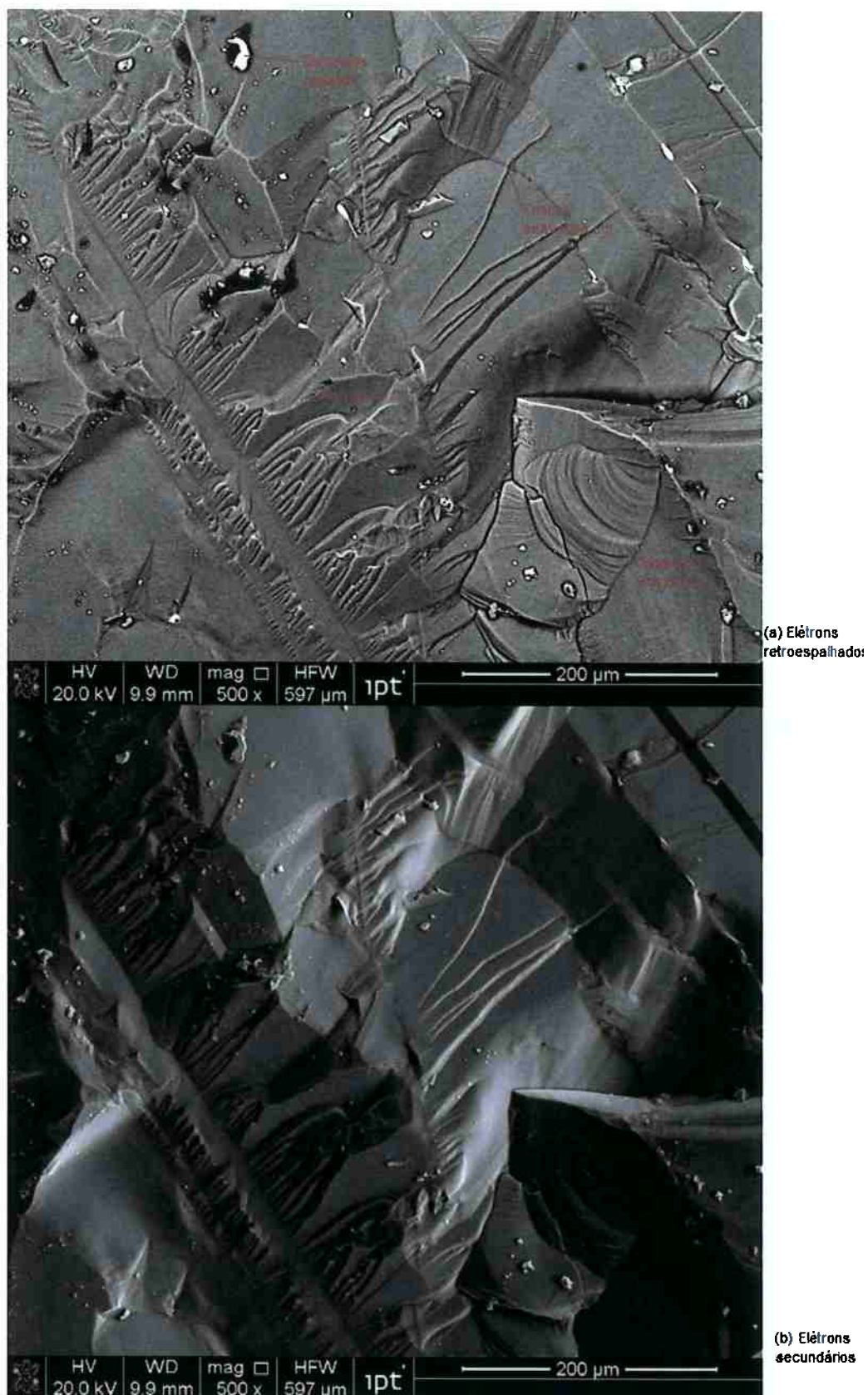
Figura 36- Imagens da superfície de fratura dos lingotes EB46 observadas no MEV. (a) imagem produzida por elétrons retroespalhados. (b) imagem produzida por elétrons secundários.
