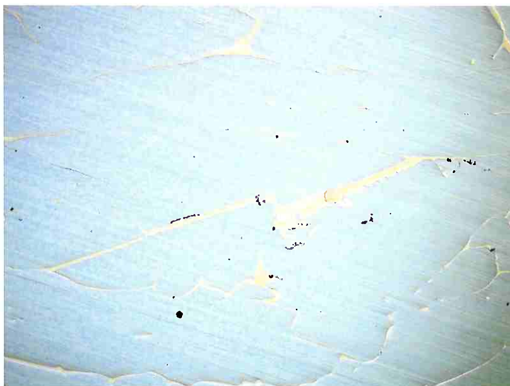
Figura 7- Precipitação de elementos menos solúveis nos contornos e no interior dos grãos de um lingote de Si observados por microscopia óptica no Instituto de Pesquisas Tecnológicas – IPT. Aumento de 500x.
