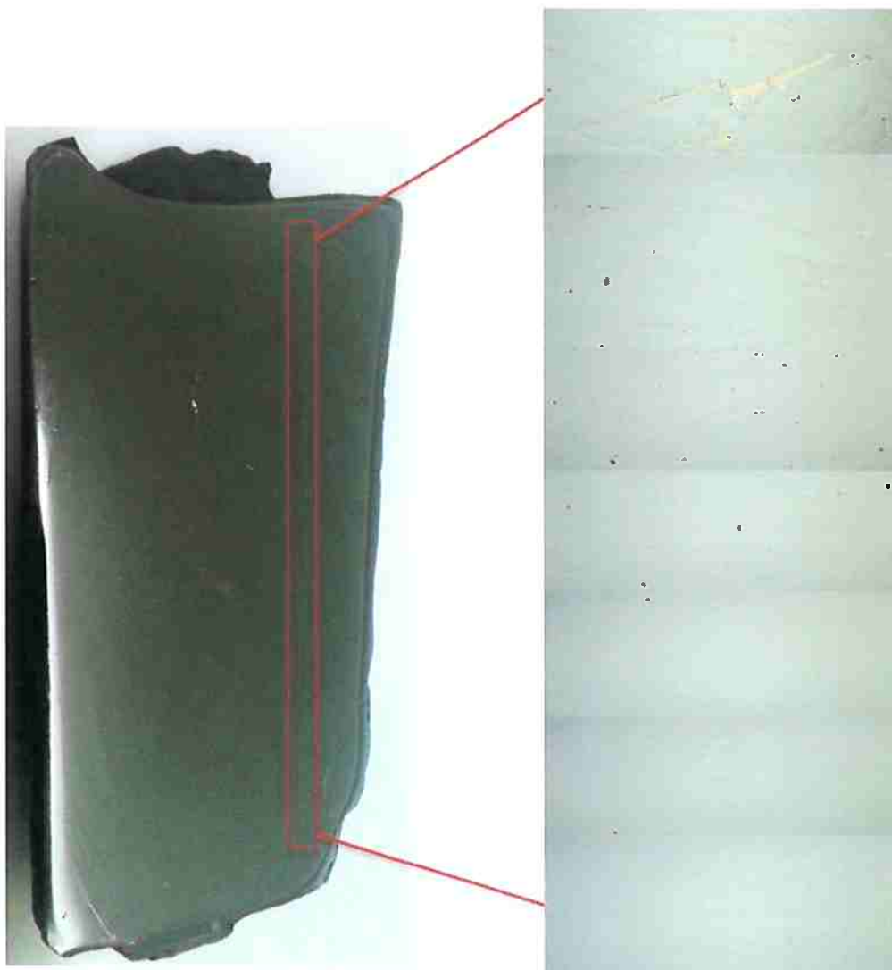
Figura 35- Micrografia do lingote EB48. Observação de impureza na direção longitudinal por microscopia ótica. Aumento de 200x.
