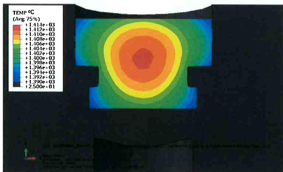
Figura 47- Tempo t=50s na simulação da evolução da temperatura na solidificação de um iniciador de silício. Imagem para um intervalo de temperatura de 1414 a 1390 °C.
