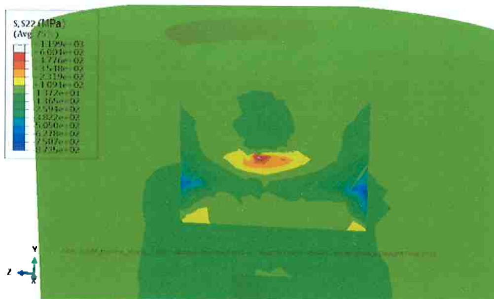
Figura 55- Distribuição de tensões térmicas normais ao plano XZ próximo das bordas dos braços do suporte de cobre em aproximadamente 1,3 segundos, após a solidificação do lingote.
