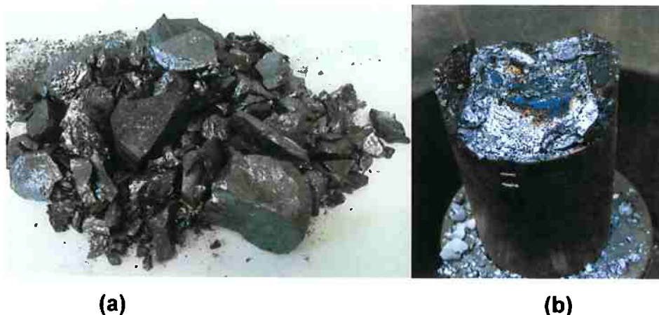
Figura 31- Corrida EB44. (a) fragmentos do lingote EB44. (b) mostra o suporte de cobre com a outra parte fraturada do lingote. Observa-se que a fratura é relativamente plana e que ocorre na borda superior dos braços do suporte de cobre.
