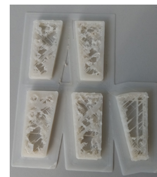
Figura 211: Resultado da impressão com a máquina de bico extrusor entupido. As peças não foram preenchidas corretamente.
