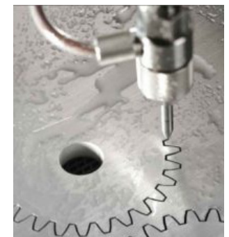
Figura 137: Máquina de corta a jato de água (processo subtrativo).
