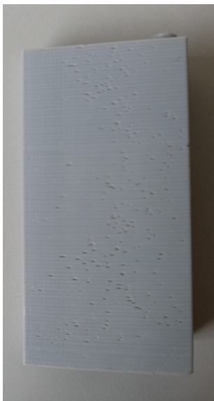
Figura 225: Peça em ABS com deformações (furinhos) na superfície lateral devido à falha na fixação das camadas.
