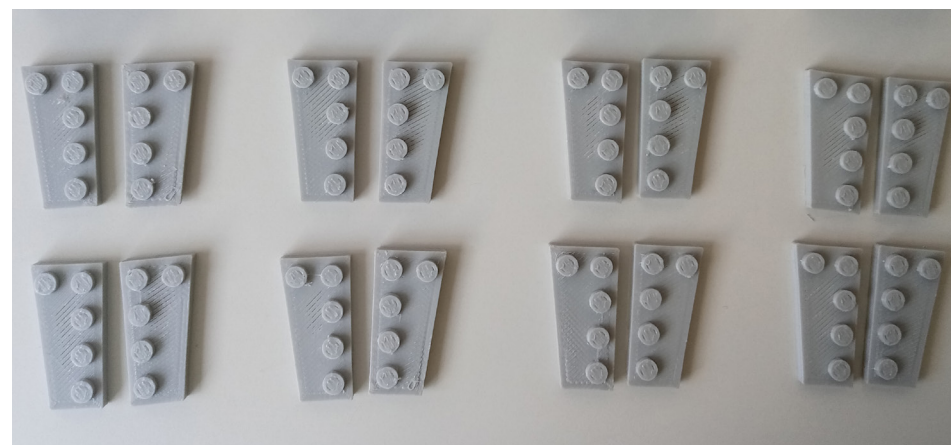
Figuras 239 e 240: No total, foram impressas 4 torres de conexão, sendo 2 em ABS (cinza claro) e 2 em PLA (cinza escuro); 8 plates de conexão esquerdo e 8 plates de conexão direito, todos em ABS.
