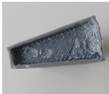
Figura 227: Peça em PLA danificada pela remoção da estrutura de apoio da impressão.
