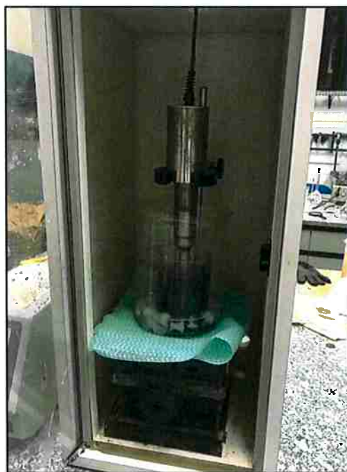
Figura 16 - Aparelhagem de ultrassom utilizada para separação mecânica das folhas de GO.
