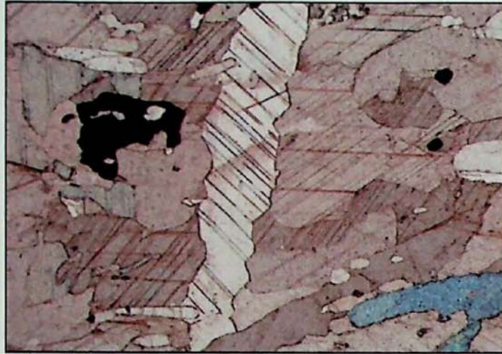
Fotomicrografia 1 - Carbonato II truncando foliação preferencial (carbonato I). Polarizadores cruzados.
