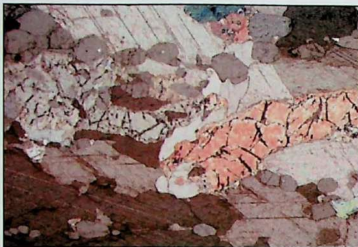
Fotomicrografia 1 - Cristal de flogopita intensamente fraturado em paragênese com carbonato I. Polarizadores cruzados.
