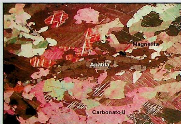
Fotomicrografia 1 - Carbonato da fase II truncando foliação definida por carbonato da fase I. Polarizadores cruzados
