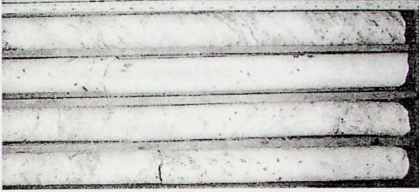
Foto 4: Carbonatito com foliação evidenciada pela orientação de magnetita e apatita em lamelas.
