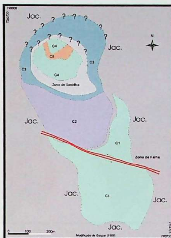
Figura 3 – Mapa das intrusões carbonatíticas. Intrusões: C1, C3 e C4 – Sôvitos calcíticos; C2 – Sôvito dolomítico; C5 – Rauhaugito. Modificado de Gaspar (1989).
