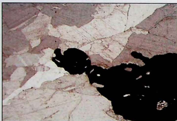
Fotomicrografia 1 - Cristal de flogopita intensamente fraturado em paragênese com carbonato I. Polarizadores cruzados.
