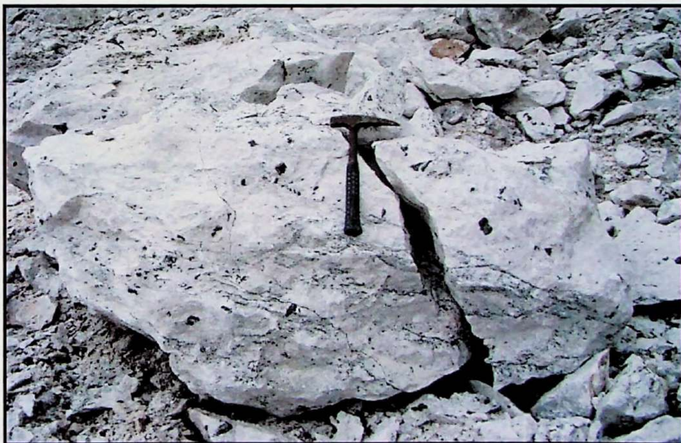
Figura 6 – Carbonatito Branco típico, com fenocristais de magnetita e apatita acicular esverdeada.
