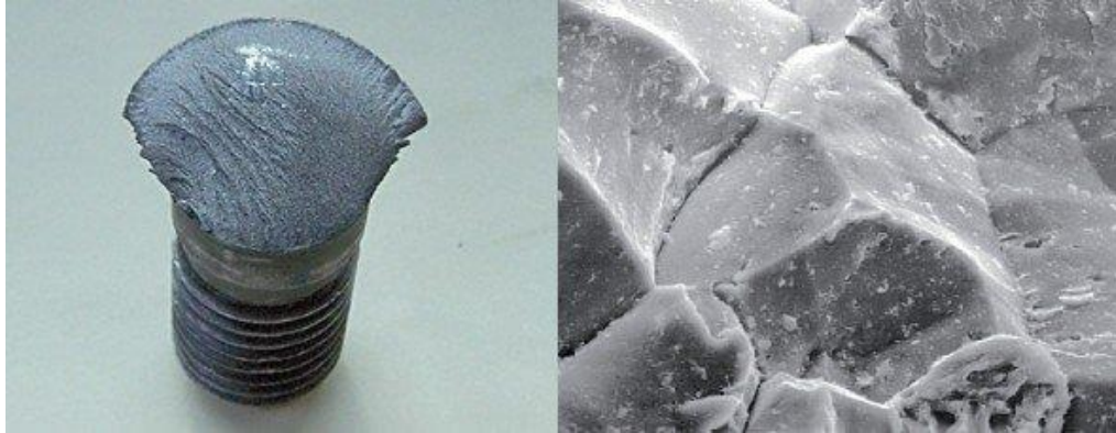
Figura 5 – Representação macro e micro do fenômeno da fragilização por hidrogênio observável por meio de uma fratura intergranular. Fonte https://www.imetllc.com/hydrogen-embrittlement-steel/ acesso em 29 dez 2022.
