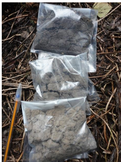
Figura 4: Amostras coletadas em um ponto de gradagem em três diferentes profundidades
