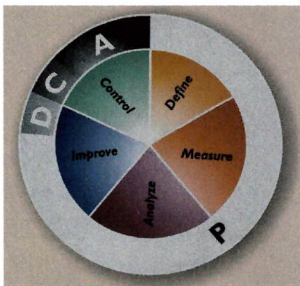
Figura 9 – Correspondência entre o Método DMAIC e o Ciclo PDCA Extraído de [WERKEMA 02]
