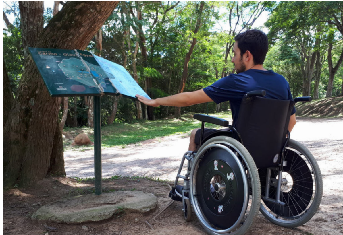
Fig. 59: Mapa tátil no Parque do Carmo. Além de estar instalado em local afastado das portarias de acesso, não há área de aproximação para P.C.R e sinalização tátil no piso. Não há nenhum tipo de sinalização para deficientes visuais. Fonte: da autora (2019)
