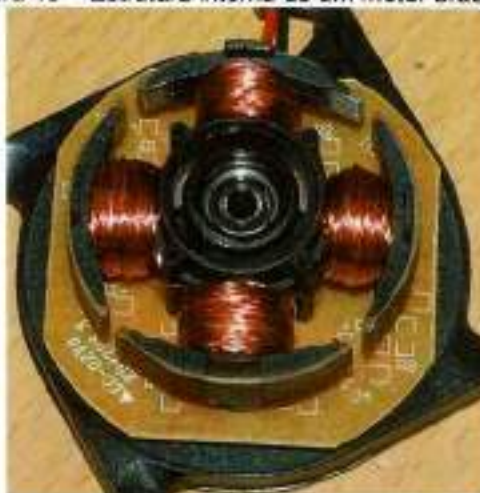
Figura 13 – Estrutura interna de um motor brushless
