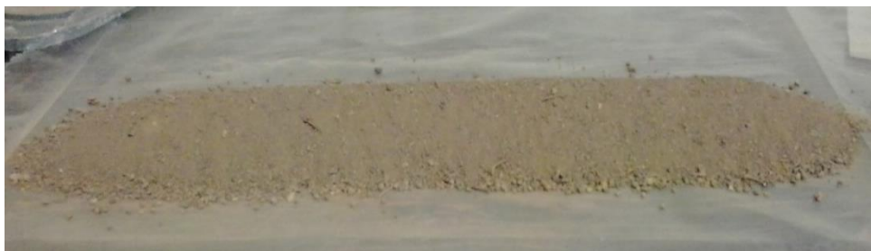
Figura 8 - Pilha alongada amostra E1-P3 (0-20cm) – Procedimento de quarteamento das amostras de solo
