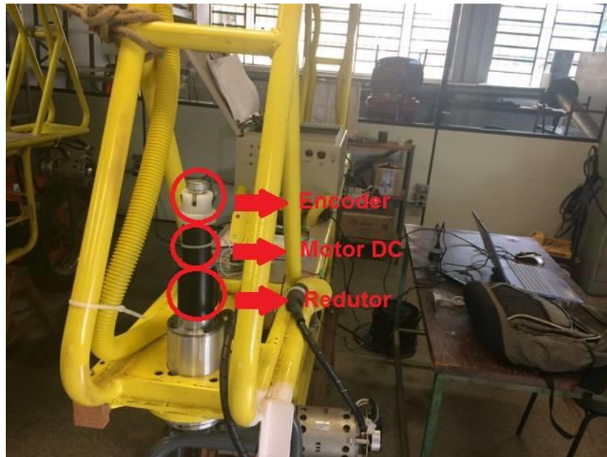
Figura 47 - Conjunto encoder, motor e redutor na validação do modelo de esterço
