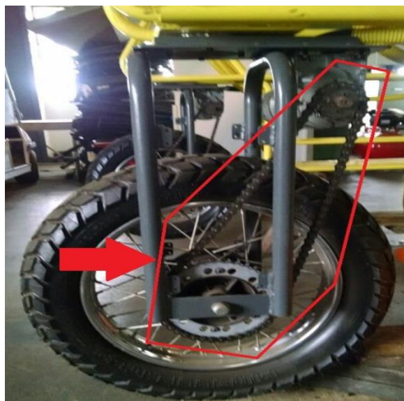
Figura 39 - Sistema coroa-corrente-pinhão do RAM
