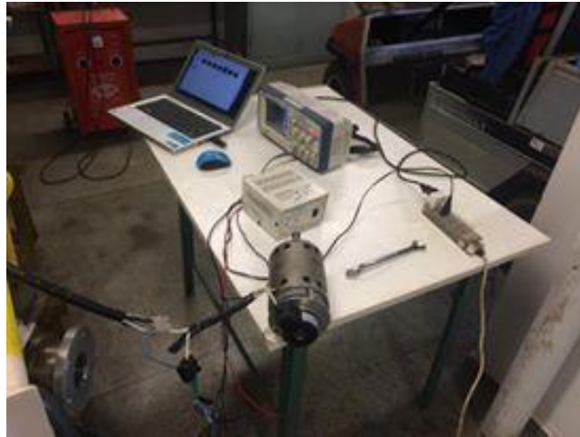
Figura 54 - Montagem experimental para obtenção da constante de tempo do motor Bosch
