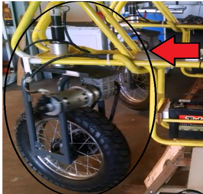
Figura 21 - Sistemas de tração e esterçamento do RAM
