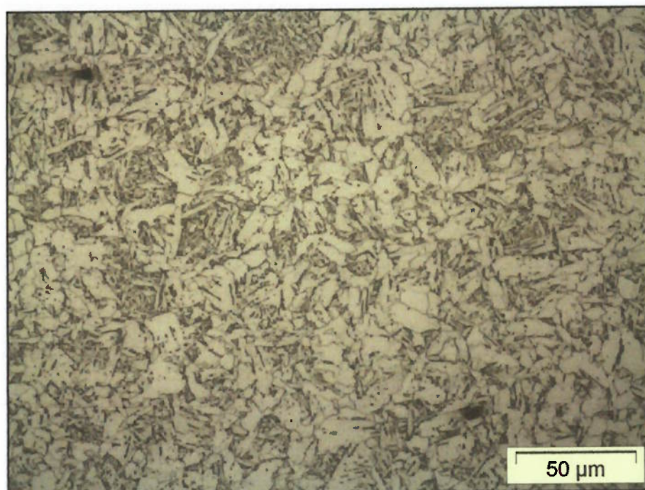
Figura 5.27 – Microestrutura – ZAC-calha: Energia de soldagem 1,58 kJ/mm - Reagente utilizado para ataque químico: nital 3% - Seção analisada: longitudinal - Ampliação: 500 vezes – Avaliação: ferrita, ferrita acicular e perlita esferoidizada, com carbonetos dispersos.
