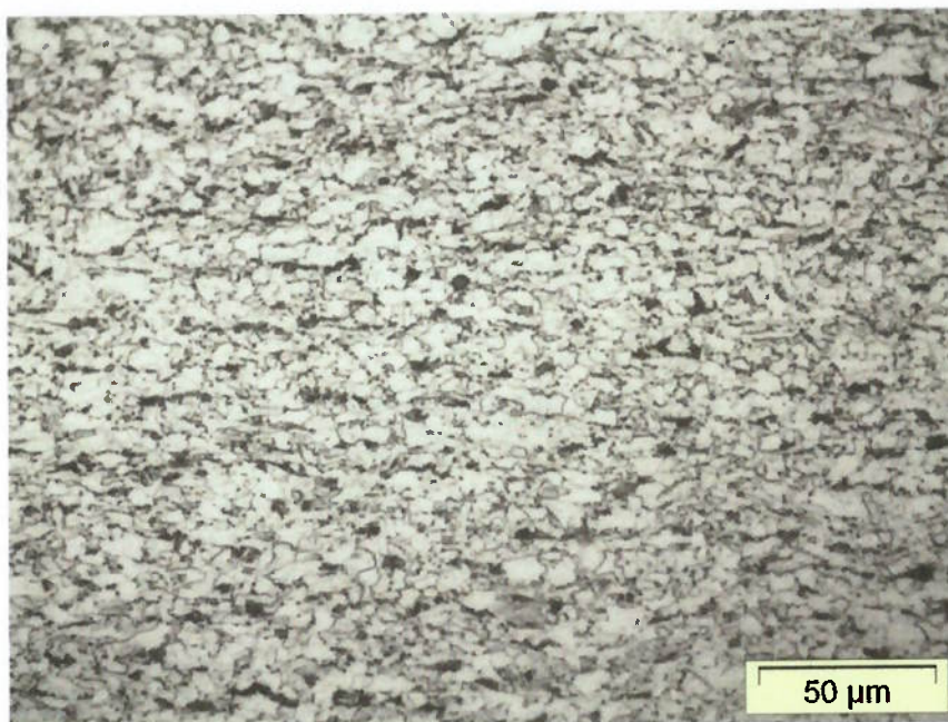
Figura 5.1 – Ensaio de micrografia – microestrutura – Aumento 500 vezes – Avaliação: perlita e ferrita com característica de tratamento térmico de normalização.
