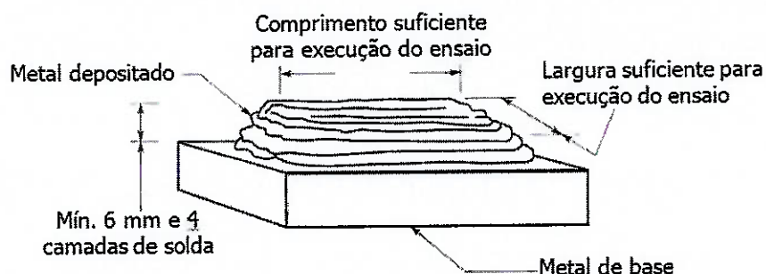
Figura 5.3 – Preparação do corpo de prova para ensaio de análise química do metal depositado.
