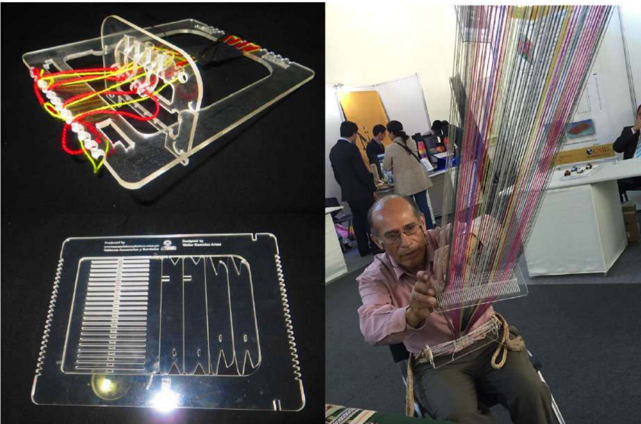
Figura 31: à esquerda, mini-tear de acrílico, fabricado em corte à laser; Figura 32: no meio, tear de cinturade acrílico, fabricado em corte à laser;
