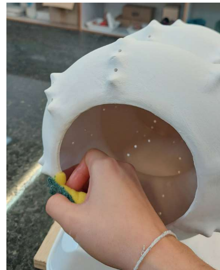
Figura 129: Limpeza da base da peça, para retirar resquícios de esmalte. Fonte: a autora.
