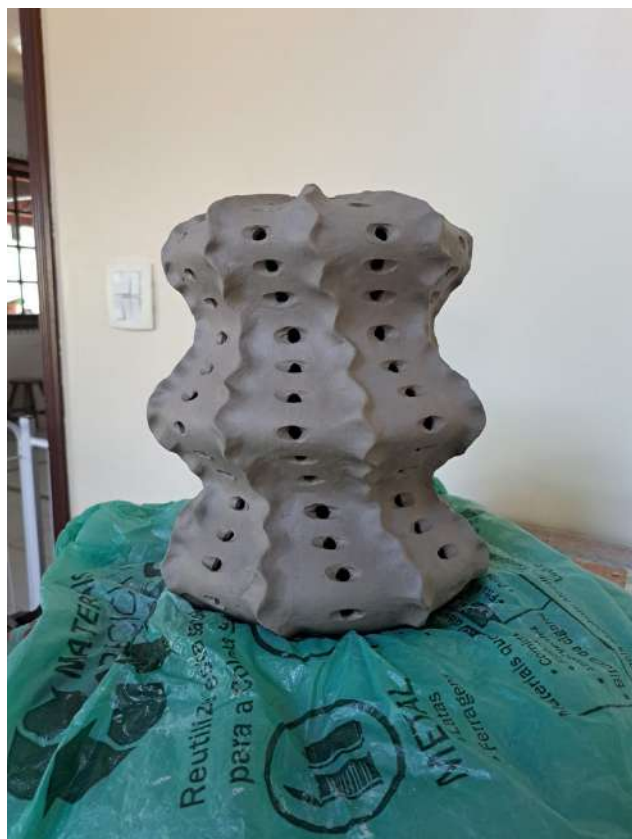
Figura 113: Texturização do Teste 5 de colagem de barbotina, terceiro desmoldado
