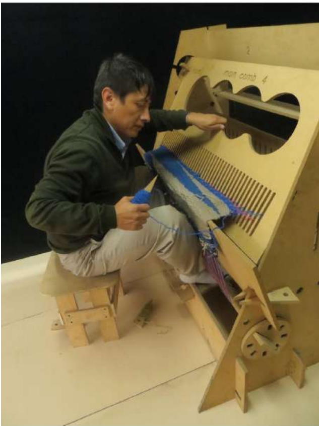
Figura 34: Walter Gonzales usando o tear de pedal, de compensado, fabricado em CNC. Fonte: HERRERA, 2016.
