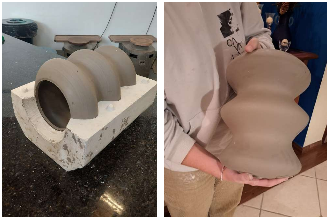
Figura 106 e 107: Peças feitas em argila Marfim sendo desmoldadas. Fonte: a autora.
