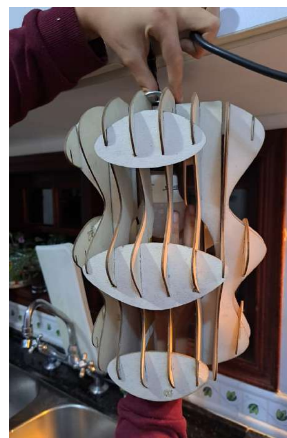
Figuras 96, 97, 98 e 99: modelos volumétricos com iluminação conectada. À direita superior e esquerda inferior, análise do tamanho da abertura da peça para manuseio da lâmpada. Fonte: a autora.
