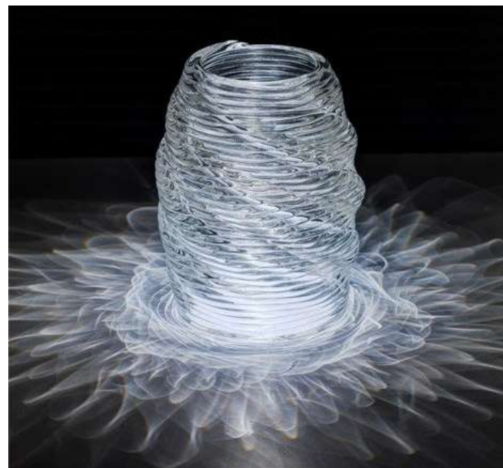
Figura 28: técnica de impressão 3D a partir da fundição de vidro, desenvolvida por Neri Oxman e seu grupo de estudantes, no MIT Media Lab. Fonte: Neri Oxman develops glass 3D printing technique
