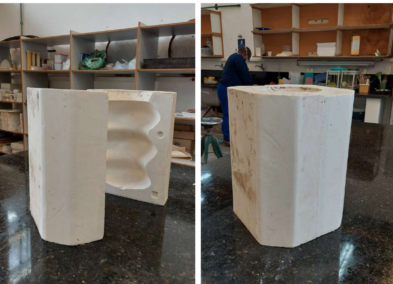
Figura 104 e 105: Molde 2 pronto para uso, após ser nivelado e desbastado nas arestas. Fonte: a autora.
