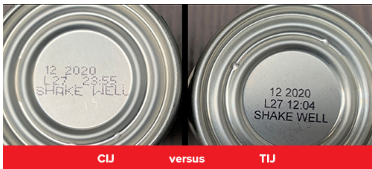
Fig. 1: comparação entre a aplicação das tecnologias CIJ e TIJ. Fonte: Weber Marking blog, 2021 (1)
