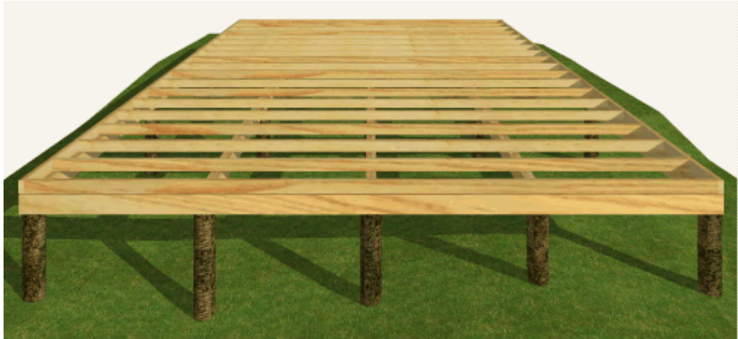
Figura 34 - Barroteamento do piso sob fundação em estacas de madeira
