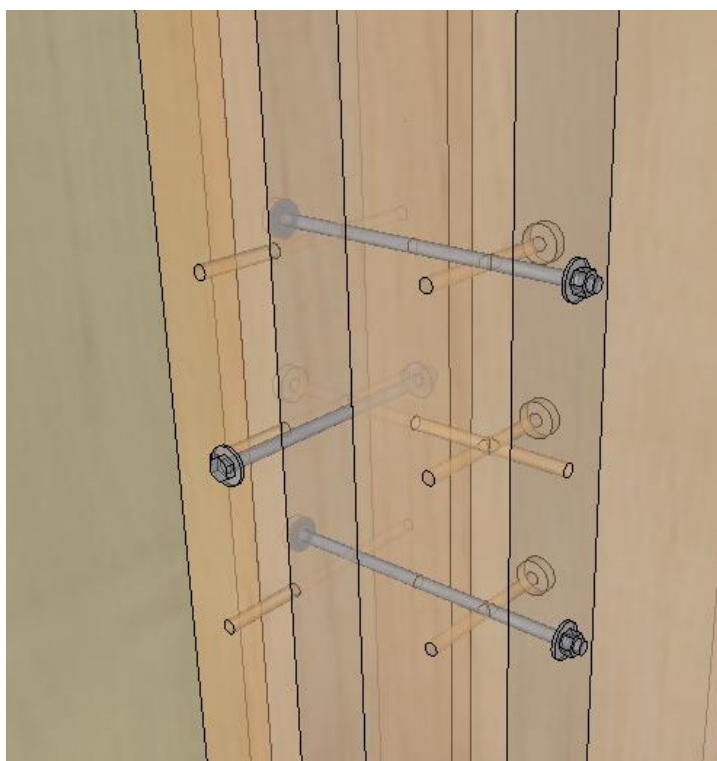
Figura 68 - Detalhe da ligação central, em raio-x, de três módulos de parede
