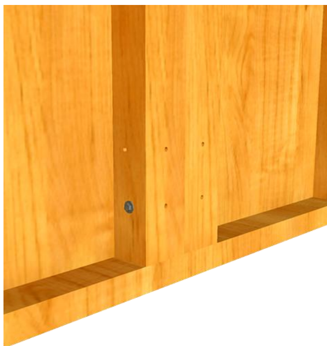
Figura 66 - Detalhe da ligação inferior entre dois módulos de parede
