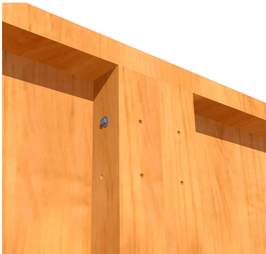
Figura 64 - Detalhe da ligação superior entre dois módulos de parede
