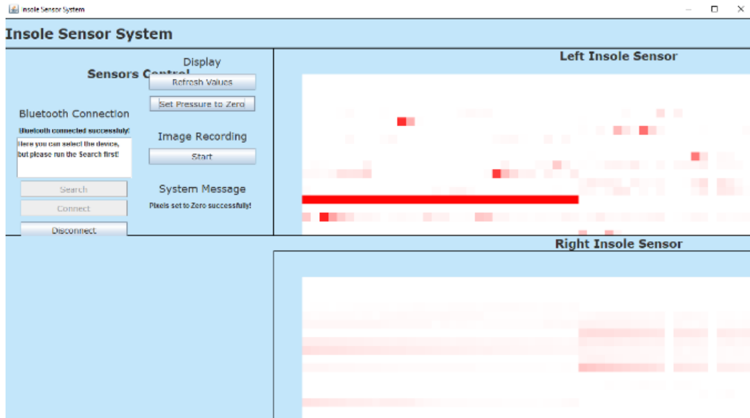
Figura 32: Imagens de aquisição da palmilha com 3.3V no pino 34 do terminal A/D
