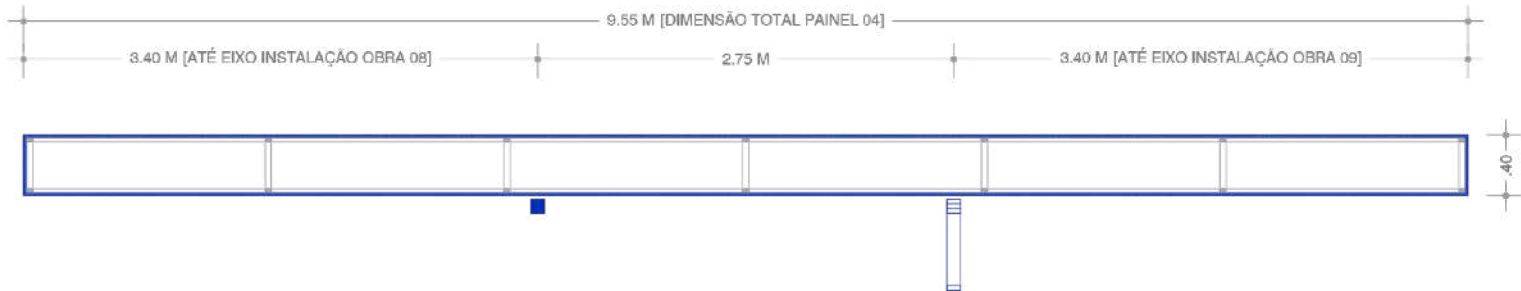
PLANTA PAINEL 04 ESCALA 1:50 PAINEL COM REQUADRO DE SARRAFOS, REVESTIDO COM COMPENSADO NAVAL #20 MM. TODAS AS FACES APARENTES MASSEADAS COM ACABAMENTO EM TINTA BRANCA FOSCA.
