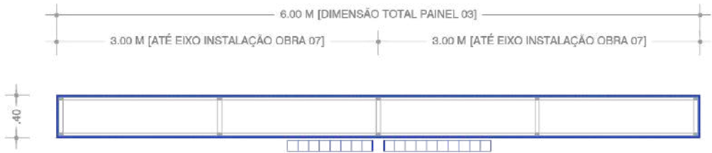
PLANTA PAINEL 03 ESCALA 1:50 PAINEL COM REQUADRO DE SARRAFOS, REVESTIDO COM COMPENSADO NAVAL #20 MM. TODAS AS FACES APARENTES MASSEADAS COM ACABAMENTO EM TINTA BRANCA FOSCA.
