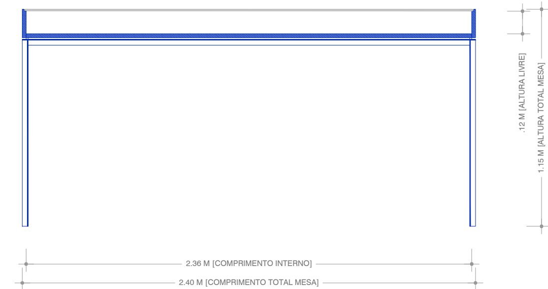
CORTE LONGITUDINAL MESA DE CADERNOS 01 E 02 ESCALA 1:20
