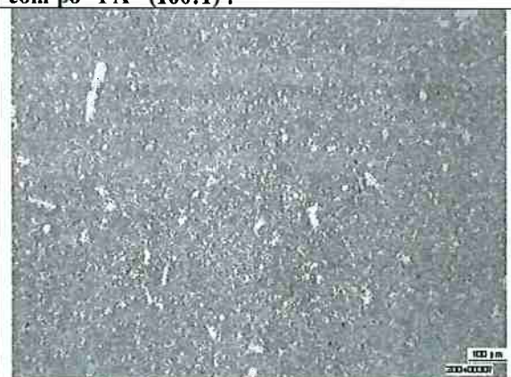
Figura 6.14 – Microestrutura da pastilha feita com pó “PB” (100:1) 4 .
