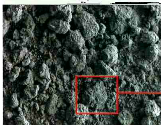
Figura 6.8 – Microestrutura da parte fina do pó granulado “PB” (<0,3mm) (50:1) 2 .
