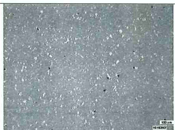
Figura 6.12 – Microestrutura da pastilha feita com pó “PA” (100:1) 4 .
