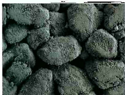
Figura 6.7 – Microestrutura do pó granulado “PB” (partículas entre 0,3 e 0,8mm) (50:1) 2 .
