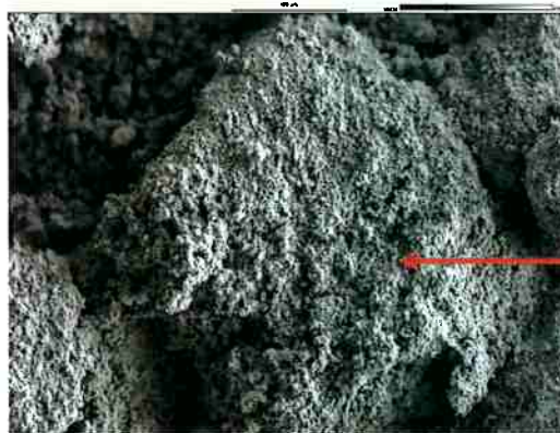
Figura 6.6 – Microestrutura da parte fina do pó granulado “PB” (<0,3mm) (250:1) 1 .
