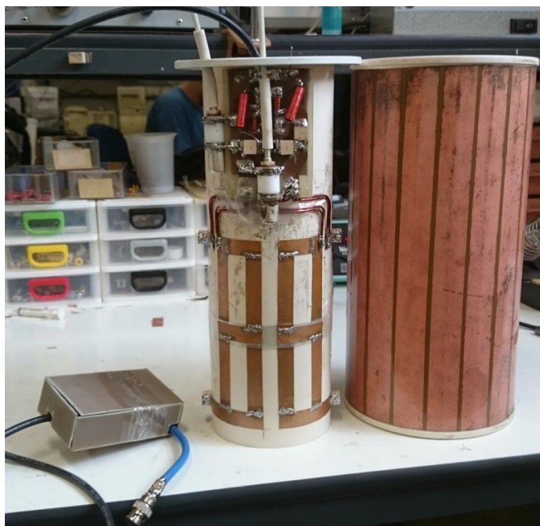
Figura 7-17 O conjunto completo, filtro, bobina SDC, circuito e BSDF.
