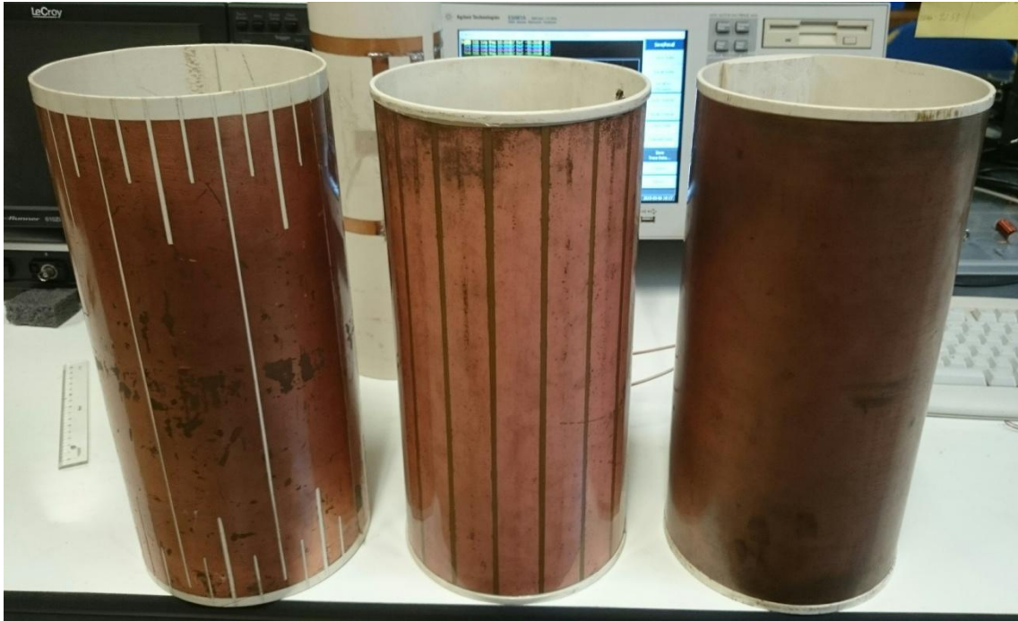
Figura 4-6 Blindagem parcialmente segmentada(esquerda), blindagem segmentada de dupla face(centro) e blindagem contínua(direita).
