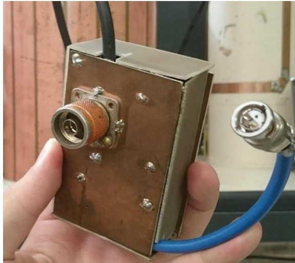
Figura 5-5 Vista da parte de trás do filtro, já com uma caixa blindada para proteção. Conector tipo N a esquerda e conector tipo TWINAX a direita.
