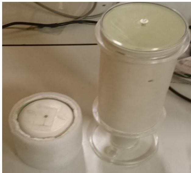
Figura 3-5 Phantoms usados como amostras para as bobinas. Esférico (esquerda) com cloreto de sódio, e cilíndrico com sulfato de cobre (direita).
