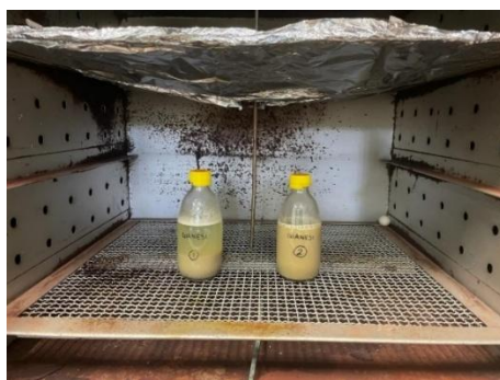
Figura 5 - Reatores com as misturas de argila e solução ácida colocadas na estufa (início do processo) (Autora, 2023).
