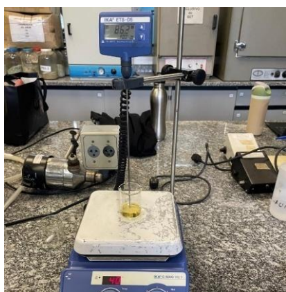
Figura 16 - Sistema de transesterificação (Autora, 2025)
