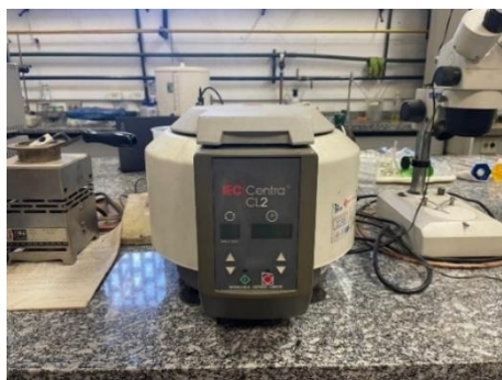
Figura 12 – Centrífuga utilizada para separação do óleo / argila
