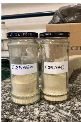
Figura 8 - Amostras de argila modificadas (#200 mesh) (Autora, 2023)
