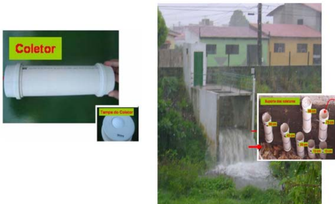
Figura 9 - a. Coletor e detalhe da tampa; 9- b. Suporte para os coletores de água no tanque de lagoa de infiltração. Fonte: UFRN (s/d).
