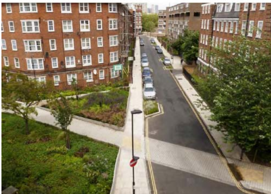
Figura 66 - Elementos de biorretenção alinhados ao tráfego. Alguns jardins de chuva podem substituir vagas de carro, como esse exemplo em Portland, Oregon. Fonte: Moura, 2014.
