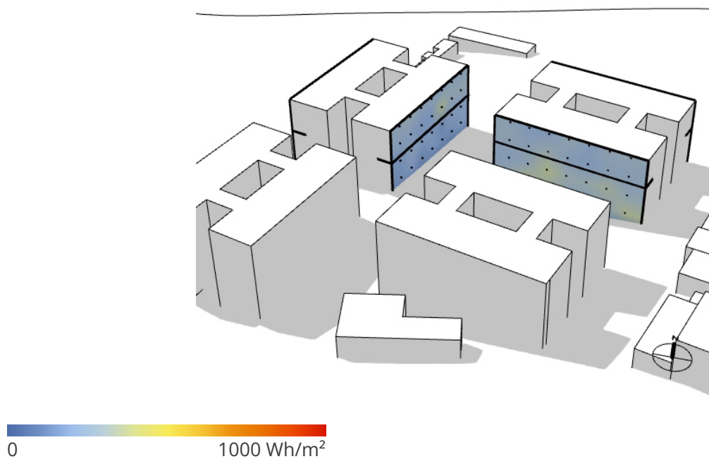
Figura 202 - Radiação incidente durante o equinócio, 15h, nas fachadas Sul e Leste
