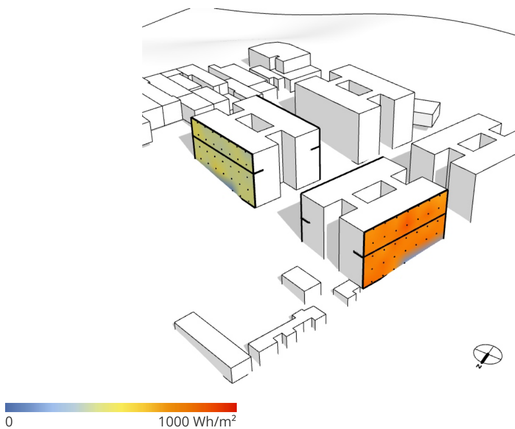
Figura 201 - Radiação incidente durante o equinócio, 15h, nas fachadas Norte e Oeste
