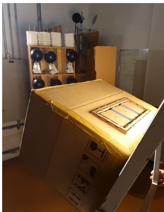
Figura 167 - Caixa posicionada simulando fachada orientada para leste, com brises rotacionando ao redor de um eixo vertical
