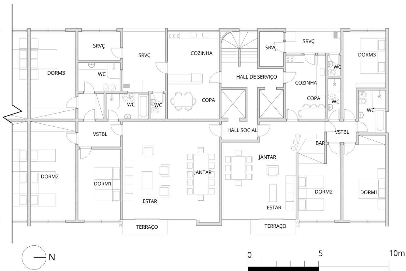
Figura 106 - Ampliação da Planta do Pavimento Tipo do Edifício Juriti, mostrando duas unidades. Redesenho da autora
