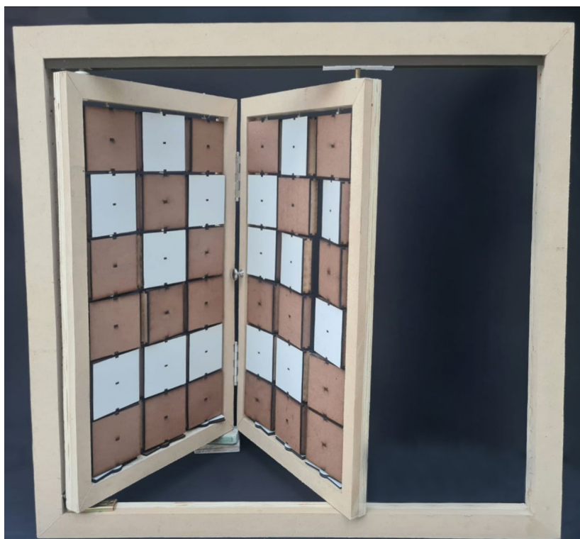
Figura 157 - Protótipo 1 finalizado, demonstrando a abertura da porta camarão. Foto da autora
