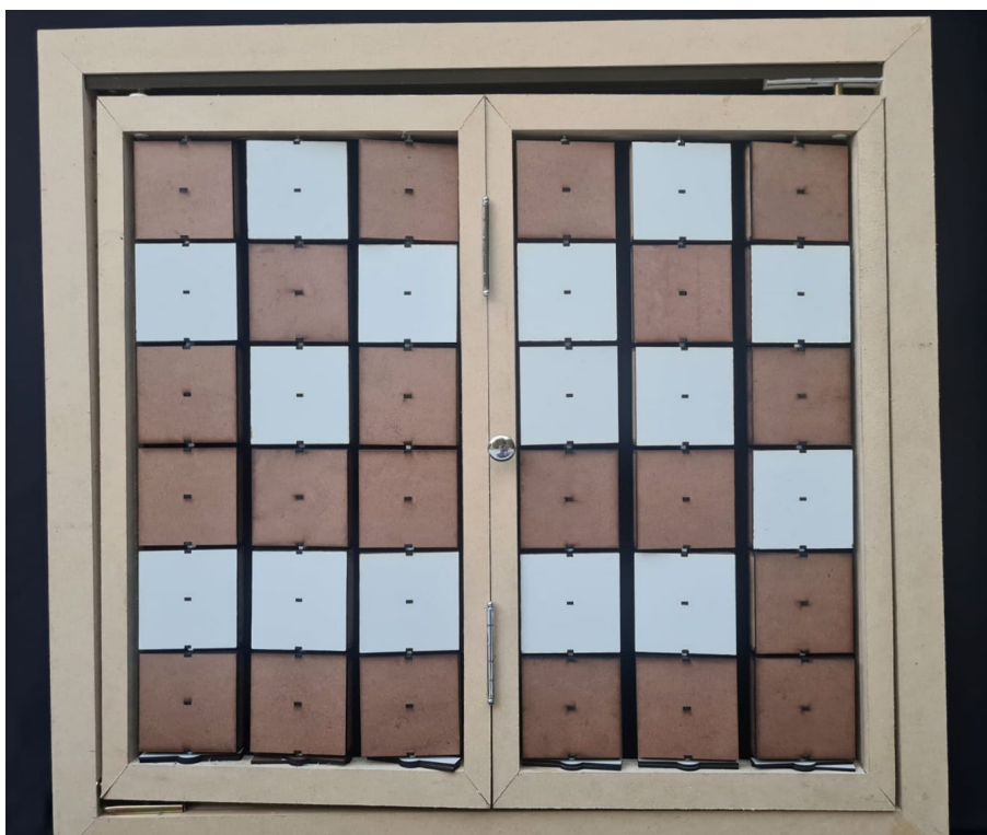
Figura 155 - Protótipo 1 finalizado, com revestimentos de mdf alternados de forma a sinalizar a aplicação de diferentes materiais nas aletas. Foto da autora
