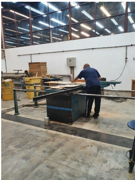
Figura 152 - Confeção das molduras utilizando serra de bancada
