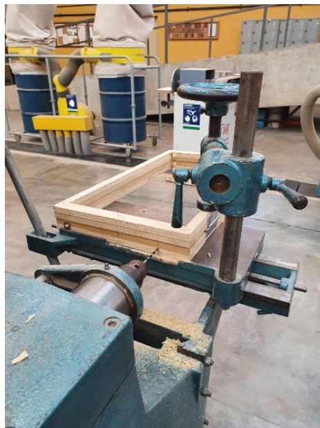
Figura 153 - Furação da peça para passagem da barra rosca
