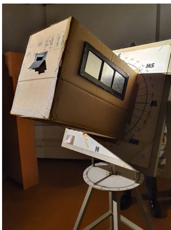
Figura 166 - Caixa posicionada simulando fachada orientada para oeste, com brises rotacionando ao redor de um eixo horizontal
