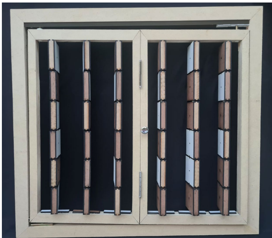
Figura 156 - Protótipo 1 finalizado com aletas rotacionadas. Foto da autora
