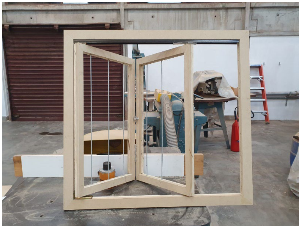
Figura 154 - Moldura com eixos (sem aletas)
