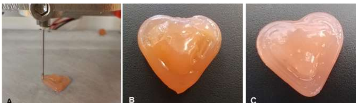
Figura 18- (A) Produção da bala mastigável por impressão 3D (B) Bala mastigável fortificada (C) Bala mastigável controle.
