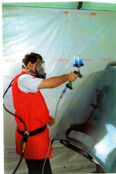
Figura 3: Respirador de linha de ar comprimido de fluxo contínuo, com cobertura do tipo facial inteira, traquéia, regulador de vazão, cinto e mangueira.
