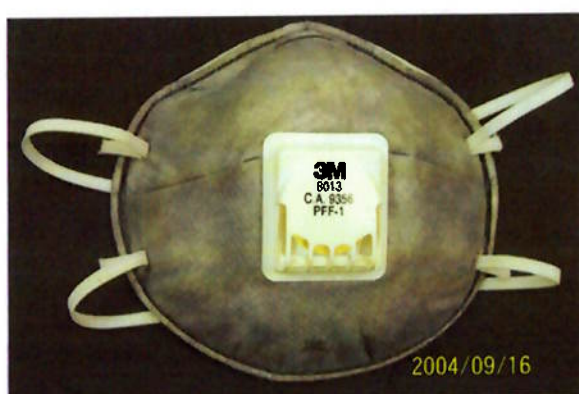
Figura 6: Respirador semifacial do tipo peça facial filtrante tipo 1 (PFF1) e filtro químico de baixa capacidade (FBC1).
