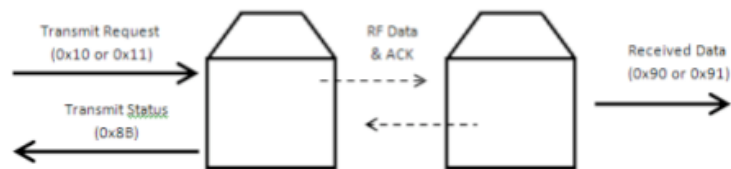
Figura 17 Ilustração da comunicação por meio de frames API. Fonte: DIGI INTERNATIONAL (2010)
