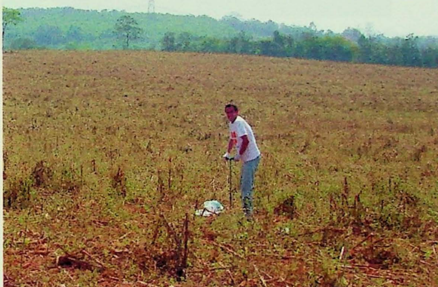
Fotografia 02 – Tradagem manual em área contígua ao aterro.
